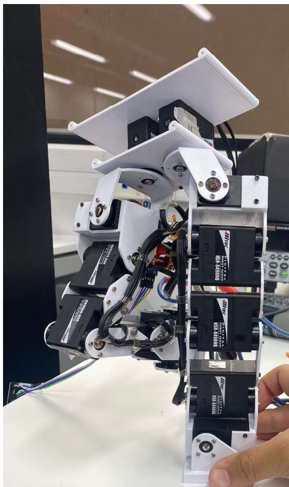
Figura 34: Prototipo de piernas del Robonova siendo controlado por el programa.
