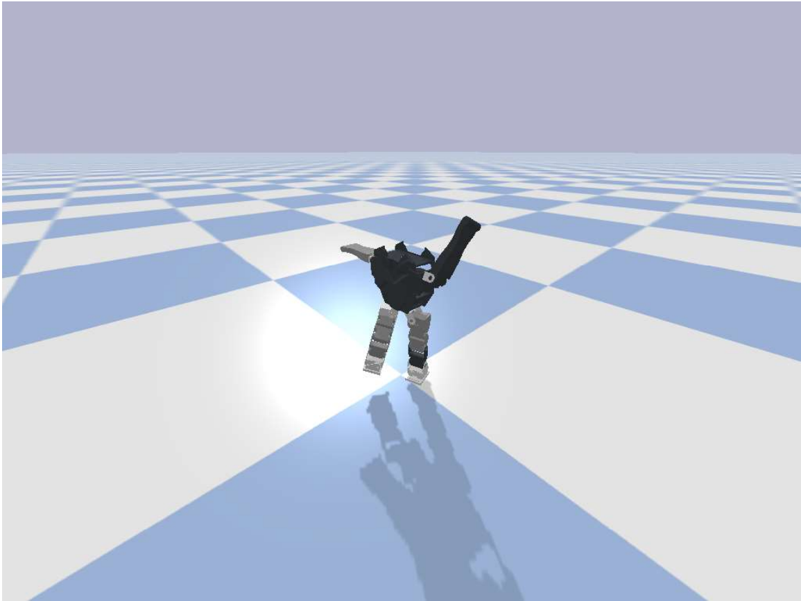
Figura 26: Simulación Robonova con posiciones de los servomotores cambiada en pyBullet.
