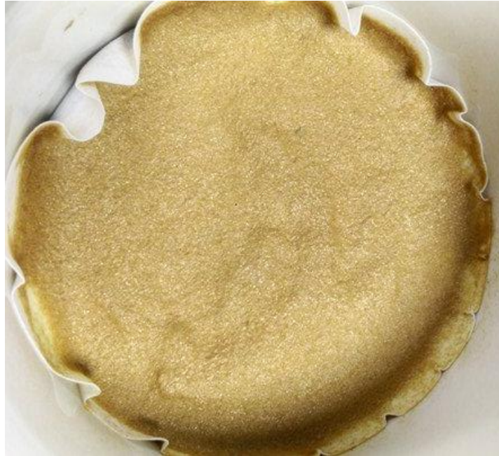
Figura 48 Harina de pupario de moscas Ceratitis capitata macho luego de desproteinización con NaOH 1M
