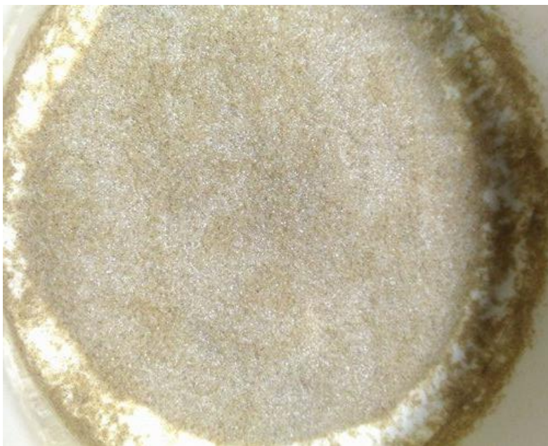
Figura 40 Harina de pupario de moscas Ceratitis capitata hembra luego de desproteínización con NaOH 1M
