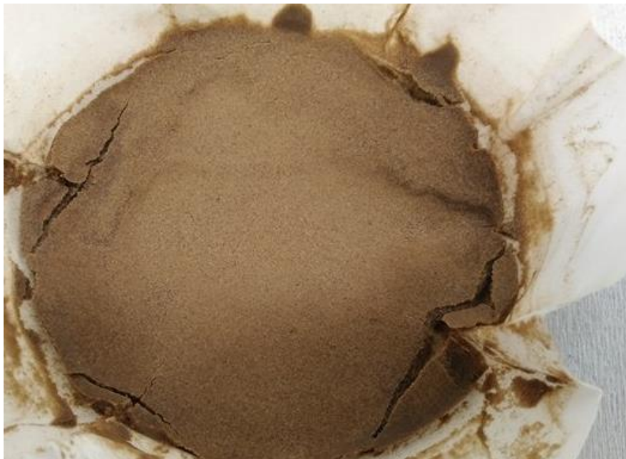
Figura 43 Harina de pupario de moscas Ceratitis capitata macho luego de acondicionamiento con ácido benzoico 0.02M
