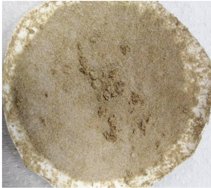
Figura 45 Harina de pupario de moscas Ceratitis capitata macho luego de desmineralización con HCl 1M
