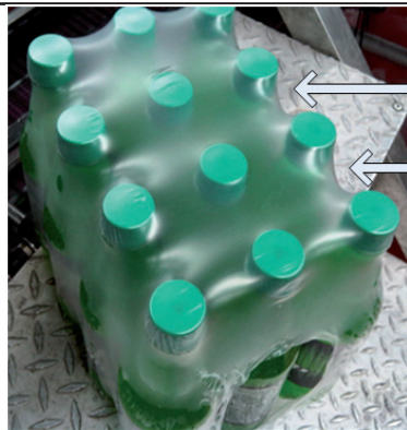
Ilustración 9: Representación de un paquete bien formado.
