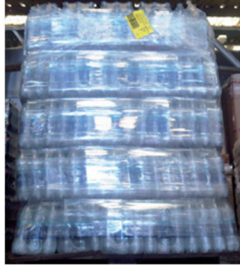
Ilustración 5: Tarima de bebida no carbonatada deformada en almacenamiento.
