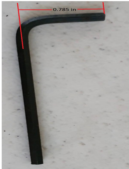
Figura 38: Distancia de la palanca de llave Allen
