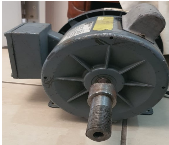
Figura 42: Motor monofásico de arranque por capacitor
