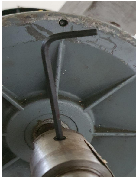
Figura 39: Posicionamiento de llave Allen
