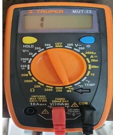
Figura 7: Posición de continuidad en el voltímetro
