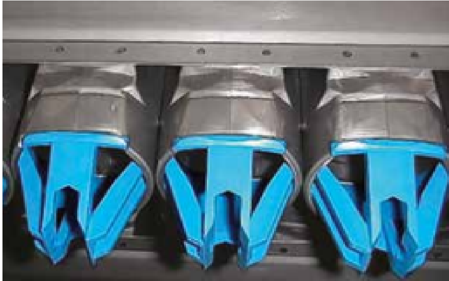
Figura 2: Alvéolos de acero para extracción de etiquetas
