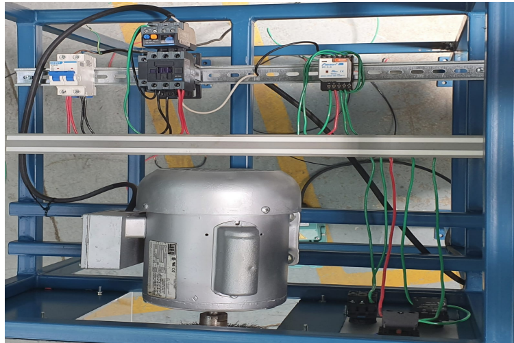
Figura 44: Sistema eléctrico físico
