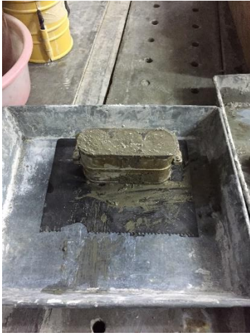
Imagen No.14: Hechura de los cilindros de graut.
