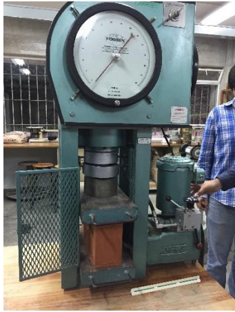
Imagen No.23: Ladrillo luego de haberse ensayado
