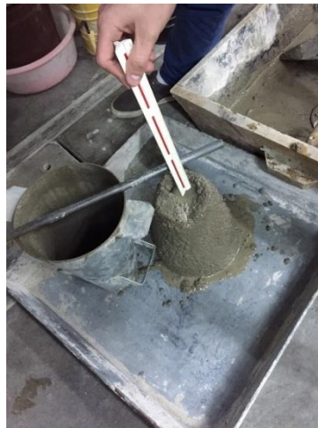
Imagen No. 13: Ensayo de cono de abrams.
