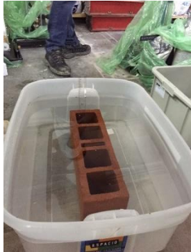
Imagen No.20: Medición de alturas del nivel de agua para determinar el área.
