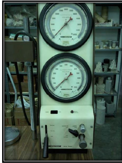
Imagen No.3 Máquina Universal Versa Tester Capacidad 60,000 Lbs.
