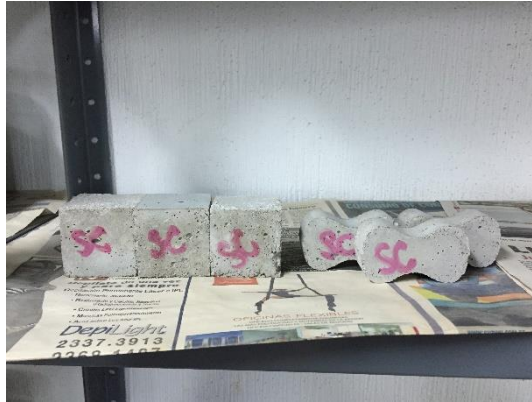
Imagen No.10: Muestras listas para los ensayos de tensión y compresión.
