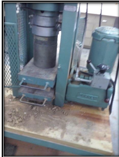
Imagen No.1 Compresora Forney Capacidad 260,000 lbs.
