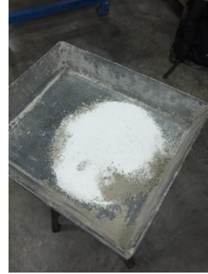
Imagen No.5: Mezcla con un 25% de Cal.
