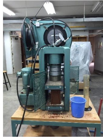
Imagen No.24: Ladrillo luego de haberse ensayado.
