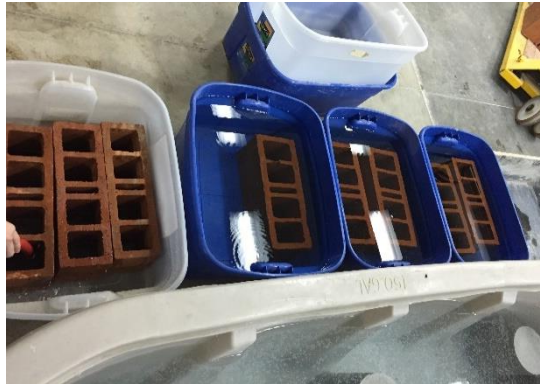
Imagen No.19: Muestras de ladrillos en proceso de saturación.
