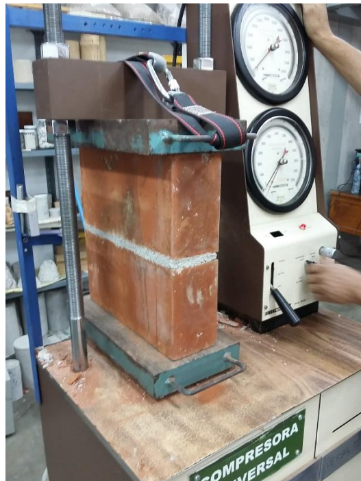
Imagen No.25 Ensayo a compresión del prisma máquina universal versa tester
