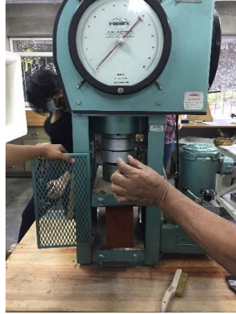
Imagen No.24: Ladrillo luego de haberse ensayado.
