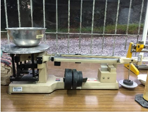
Imagen No.4: Medición de los pesos de los materiales.
