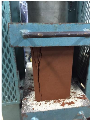
Imagen No.23: Ladrillo luego de haberse ensayado
