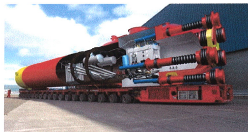
Figura 3 Uno de los eslabones que conforman la Pelamis y sus componentes internos
