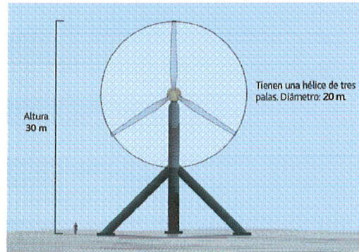
Figura 35 Esquema de la turbina tipo Lànstrøm. [2]
