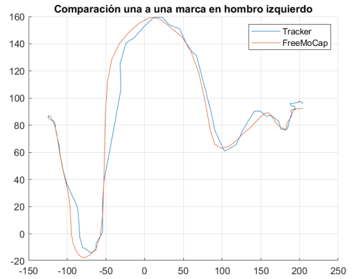
Figura 68: Comparación entre Tracker y FreeMoCap una a una de la marca en hombro izquierdo de la prueba de movimiento curvilíneo.
