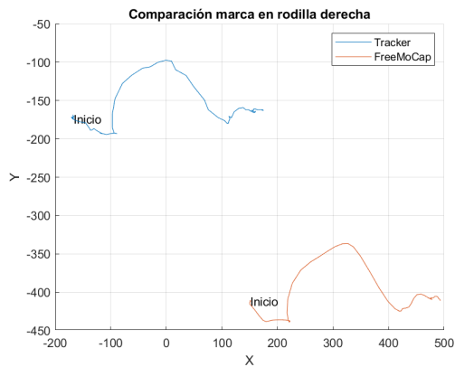
Figura 81: Comparación entre Tracker y FreeMoCap de la marca en rodilla derecha de la prueba de movimiento curvilíneo.
