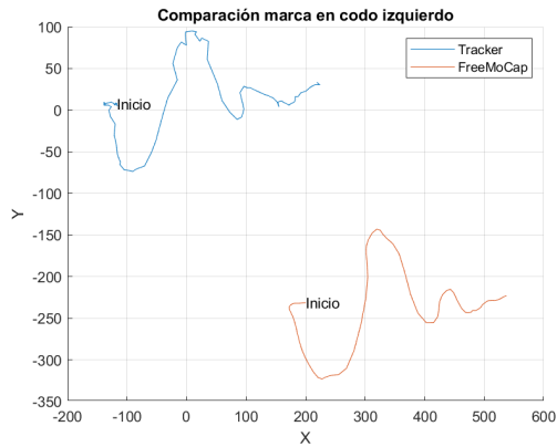
Figura 71: Comparación entre Tracker y FreeMoCap de la marca en codo izquierdo de la prueba de movimiento curvilíneo.
