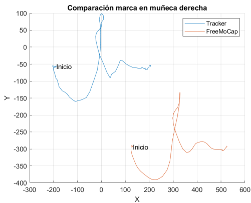
Figura 77: Comparación entre Tracker y FreeMoCap de la marca en muñeca derecha de la prueba de movimiento curvilíneo.
