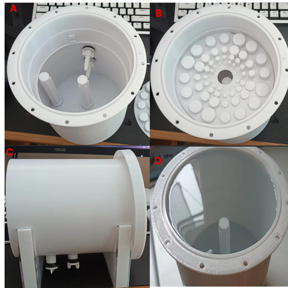
Figura 7.5: Prototipo Final del fantoma de 16 cm A) fantoma con los dos orificios para las cámaras de ionización B) fantoma con el inserto de bajo contraste C) Vista lateral del fantoma D) fantoma lleno de agua
