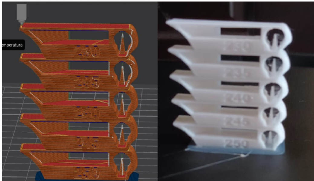
Figura B.1: Modelo para la calibración de temperatura (Izquierda). Resultado del modelo impreso (Derecha)
