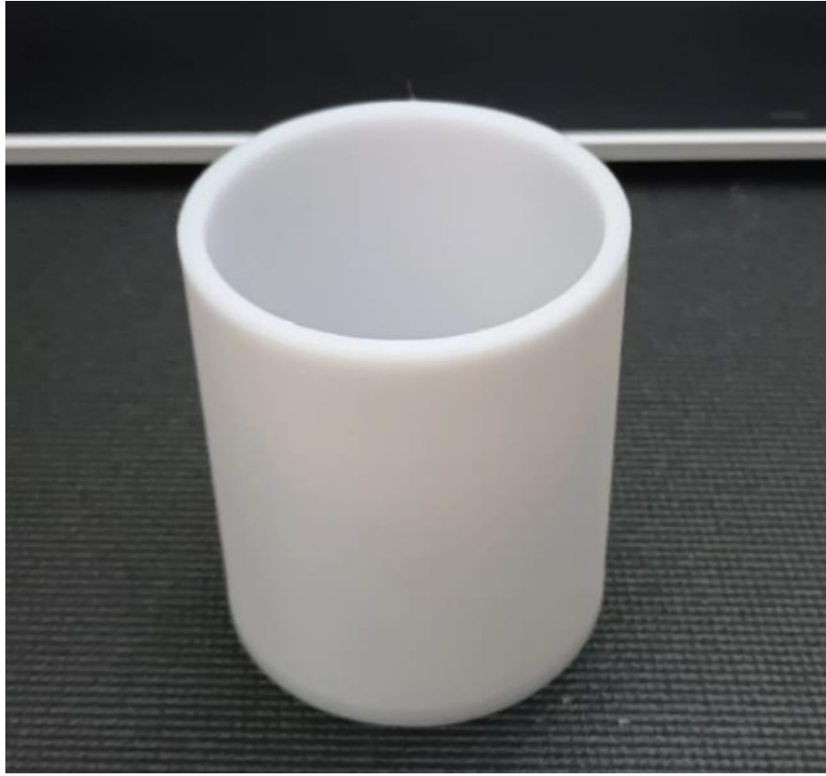
Figura B.9: Impresión del cilindro hueco utilizado el perfil de impresión calibrado
