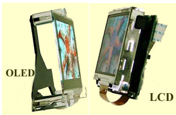
Gráfica No. 15 Comparación pantalla Oled y LCD
