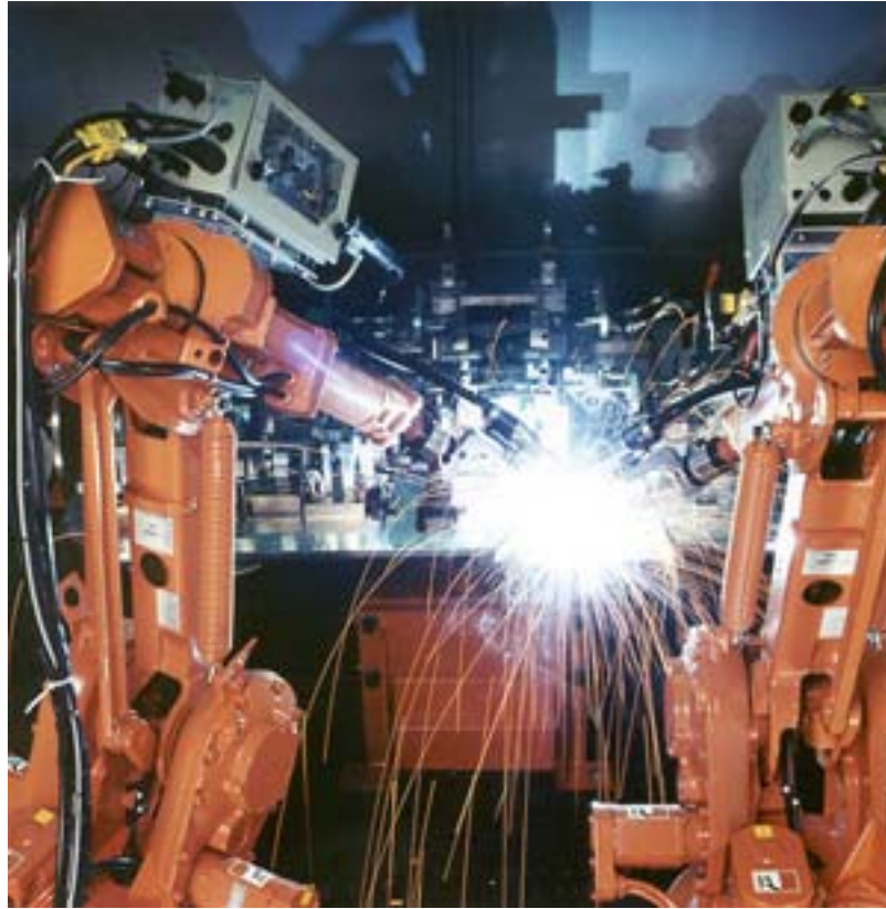
Gráfica 10 Robots para soldadura de arco (Berge, 2005)
