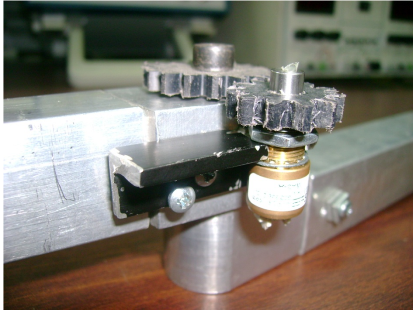
Gráfico 7 Instalación del codificador sobre la estructura
