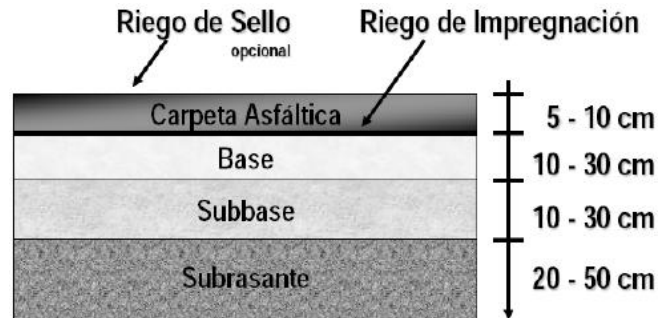
Figura 3: Sección transversal típica de un pavimento flexible.
