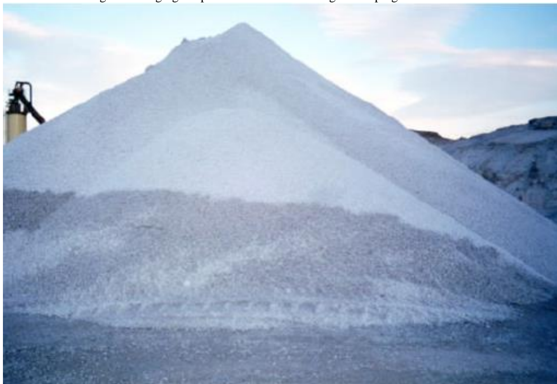
Figura 10: Agregado para mezcla asfáltica luego de impregnación con cal.
