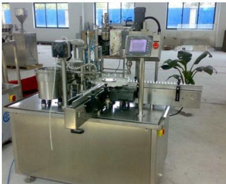
Cuadro No. 171-Especificaciones de la llenadora automática E Seng
