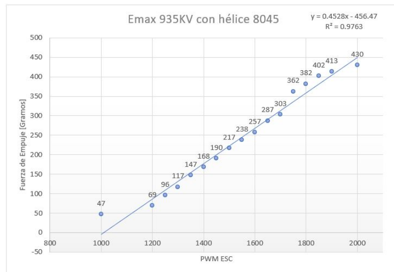
Figura 54: Motor 2 - gráfica fuerza de empuje vs PWM.
