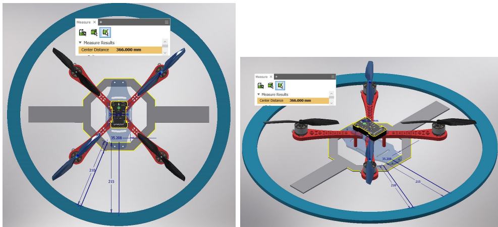
Figura 77: Síntesis iteración 3, diseño marco F366 con hélice 8045.
