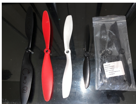
Figura 42: Hélices disponibles de 10, 9, 8 y 6 pulgadas respectivamente.
