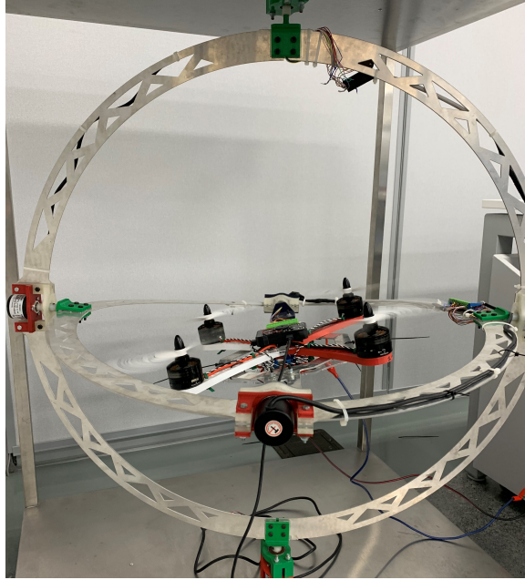
Figura 125: Movimiento cabeceo B - CH1, CH2: 1500 / CH3, CH4: 1400.
