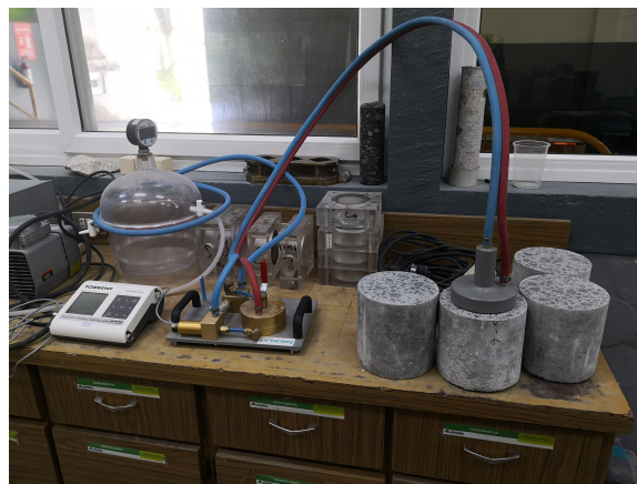
Figura 37: Medición de permeabilidad por método de Torrent Fuente: Elaboración propia
