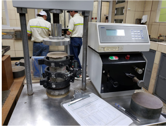
Figura 33: Ensayo de módulo de elasticidad Fuente: Elaboración propia
