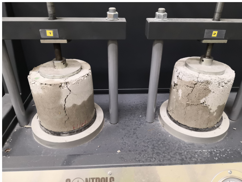
Figura 55: Agua penetrando cilindros en prueba de presión hidrostática Fuente: Elaboración propia
