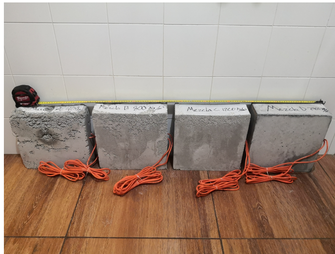
Figura 34: Muros para ensayos de conductividad térmica y acústica Fuente: Elaboración propia
