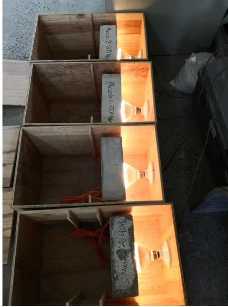
Figura 38: Pruebas de aislamiento térmico Fuente: Elaboración propia
