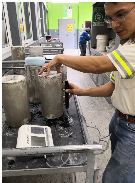
Figura 35: Medición de resistividad eléctrica Fuente: Elaboración propia
