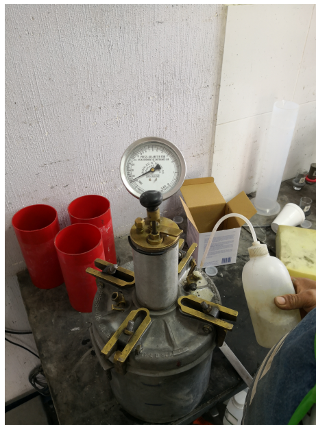
Figura 31: Medición de volumen de vacíos Fuente: Elaboración propia
