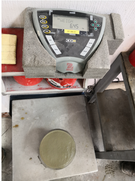
Figura 28: Medición de densidad en estado fresco Fuente: Elaboración propia
