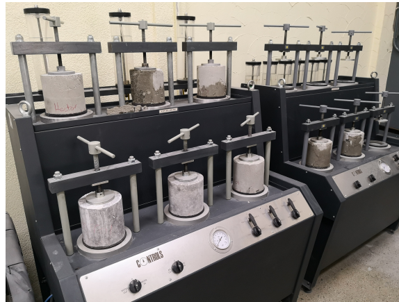
Figura 36: Medición de permeabilidad por método de presión hidrostática Fuente: Elaboración propia
