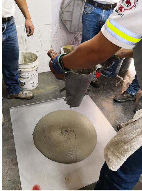
Figura 29: Ensayo de cono de Abrams invertido Fuente: Elaboración propia
