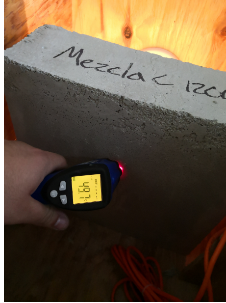
Figura 39: Medición de temperatura en caras externas Fuente: Elaboración propia
