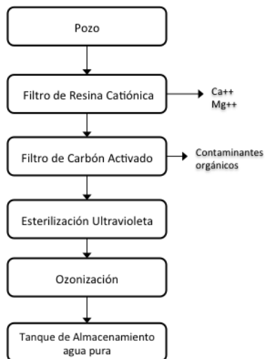
Figura No.3 Diagrama de bloques del tratamiento de agua de pozo para dilución
