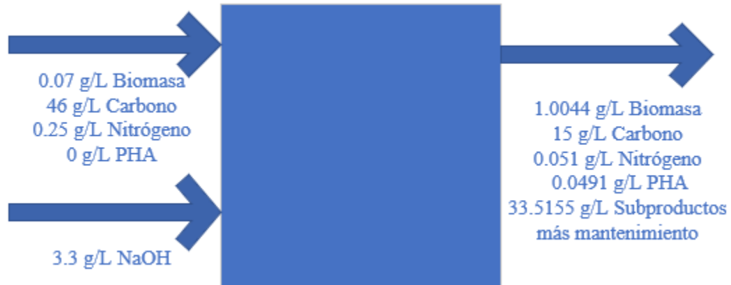
Figura 24. Balance de masa del sistema 2 del Cuadro 2 para la producción de polihidroxialcanoatos empleando Bacillus subtilis .
