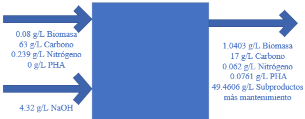
Figura 23. Balance de masa del sistema 1 del Cuadro 2 para la producción de polihidroxicanoatos empleando Bacillus subtilis .
