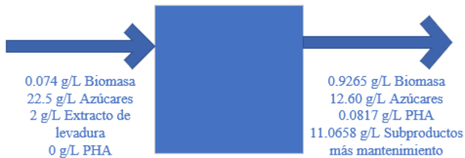
Figura 21. Balance de masa del sistema 3 del Cuadro 1 para la producción de polihidroxialcanoatos empleando Bacillus subtilis .
