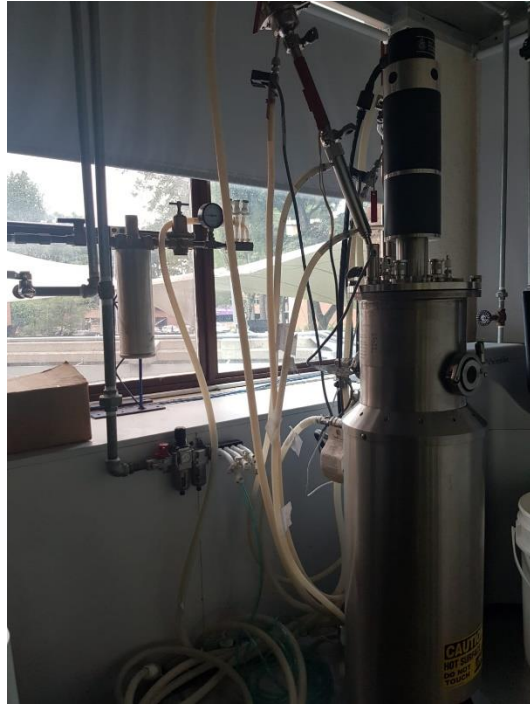
Figura 52. Fermentación de Bacillus subtilis en reactor SARTORIUS BIostat Aplus.
