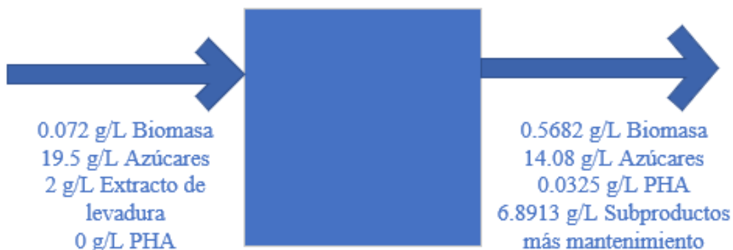
Figura 19. Balance de masa del sistema 1 del Cuadro 1 para la producción de polihidroxiclcanoatos empleando Bacillus subtilis .
