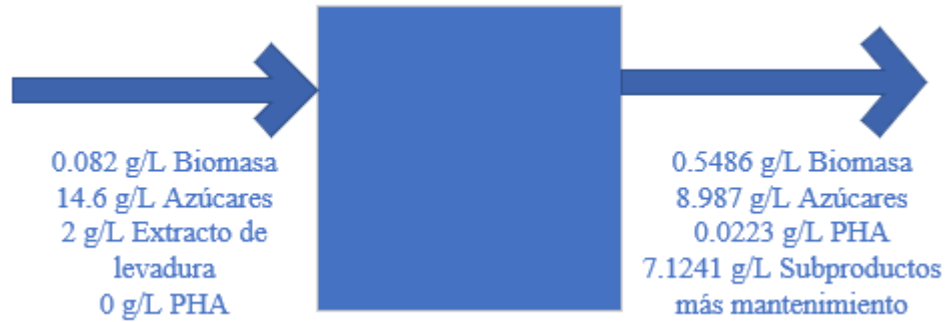
Figura 22. Balance de masa del sistema 4 del Cuadro 1 para la producción de polihidroxicanoatos empleando Bacillus subtilis .
