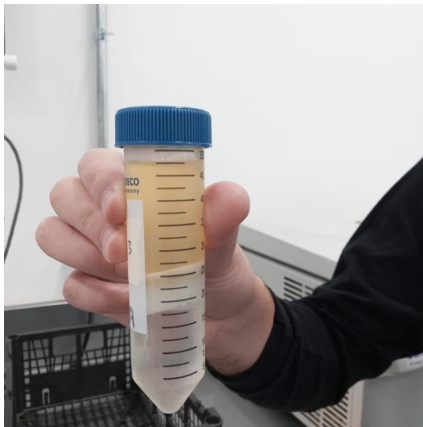
Figura 53. Purificación de polihidroxicanoatos utilizando cloroformo e hipoclorito de sodio.
