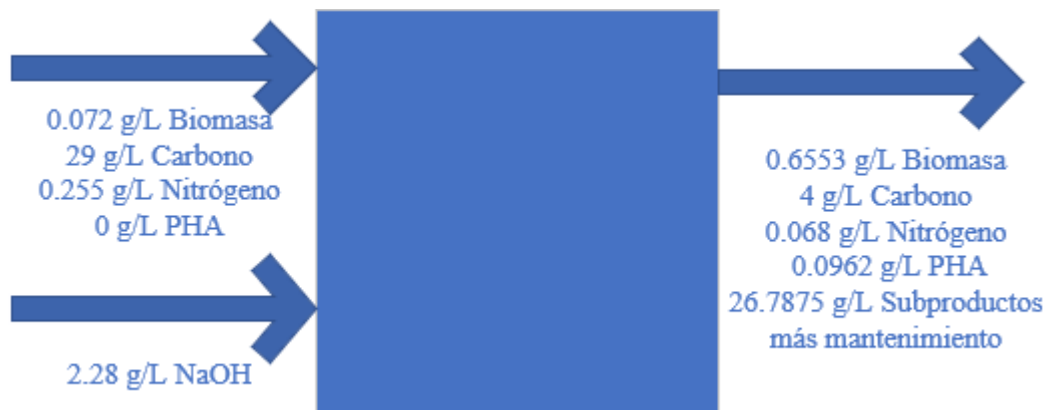
Figura 25. Balance de masa del sistema 3 del Cuadro 2 para la producción de polihidroxialcanoatos empleando Bacillus subtilis .
