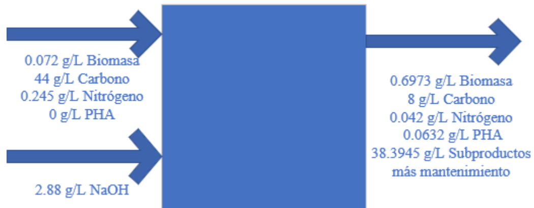
Figura 27. Balance de masa del sistema 5 del Cuadro 2 para la producción de polihidroxicanoatos empleando Bacillus subtilis .
