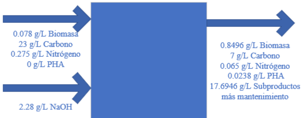
Figura 28. Balance de masa del sistema 6 del Cuadro 2 para la producción de polihidroxialcanoatos empleando Bacillus subtilis .
