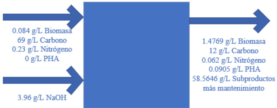
Figura 26. Balance de masa del sistema 4 del Cuadro 2 para la producción de polihidroxicanoatos empleando Bacillus subtilis .
