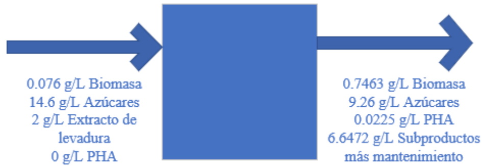
Figura 20. Balance de masa del sistema 2 del Cuadro 1 para la producción de polihidroxialcanoatos empleando Bacillus subtilis .
