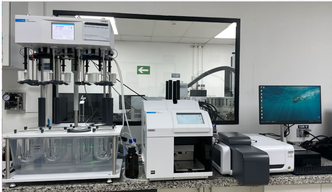
Figura 8: Disolutor automatizado modelo 708-DS, equipado con un automuestreador modelo 850-DS y un detector UV-Vis cary-60, marca Agilent
