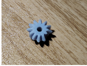
Figura 34: Fractura de dos dientes debido a estrés.
