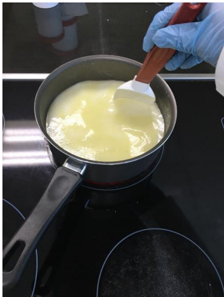
Figura 35: Mezclado de fase oleosa y fase acuosa.
