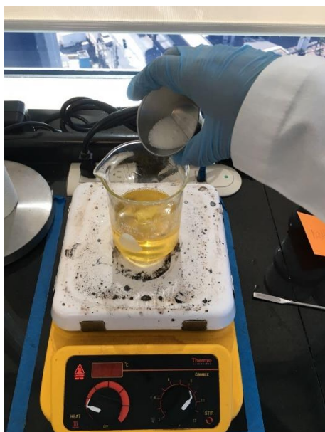
Figura 32: Adición de emulsificante a grasa fundida.
