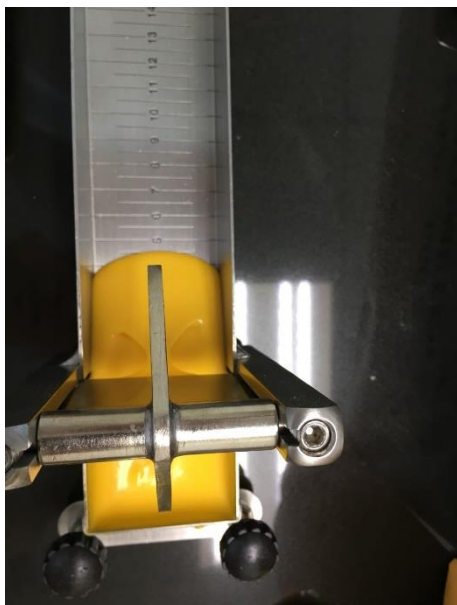
Figura 39: Medición de flujo queso objetivo (Parma).
