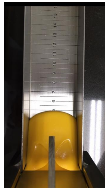
Figura 40: Medición de flujo queso análogo tipo "Spread" prototipo.
