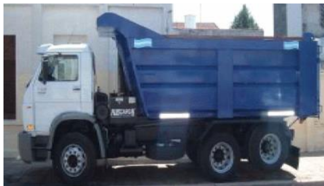
Figura No. #8. “Camión de volteo para transporte de mezcla ya estabilizada”.
