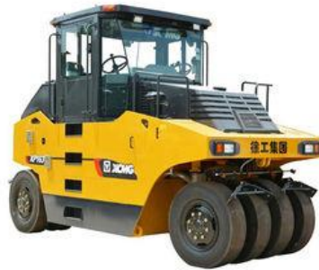
Figura No. #6. “Equipos de compactación de asfalto”. (CASALCO, 2022).
