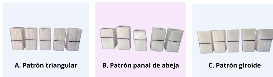
Figura 32. Probetas impresas después del ensayo de compresión para los tres patrones de relleno: (A) triangular, (B) panal de abeja y (C) giroide
