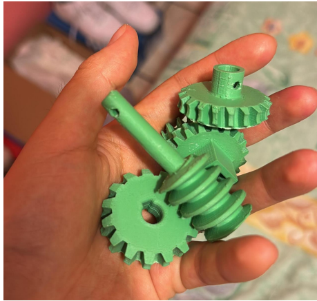
Figura 50: Primeros prototipos impresos de transmisión de potencia
