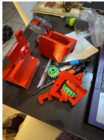
Figura 52: Postprocesado de piezas en impresión en PLA de engranajes
