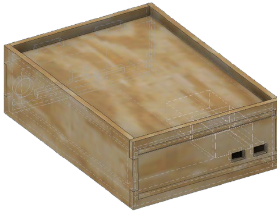
Figura 63: Carcasa de protección de la circuitería del sistema de control.
