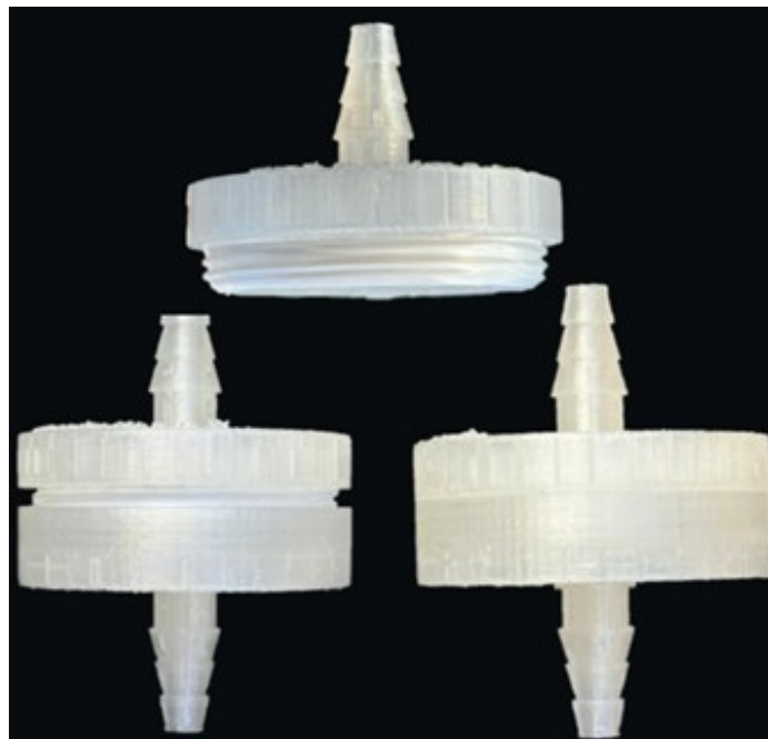
Figura 30. Ensamble de filtro impreso reutilizable con sellado por medio de cinta de teflón
