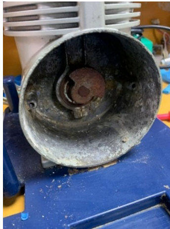
Figura 2. Daño interno por corrosión en compresor de succión médica PrecisionMedical PM50 EasyComp Imagen tomada por el autor
