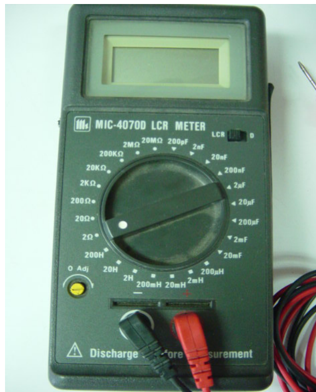
Figura O-3. Multímetro con inductímetro incluido
