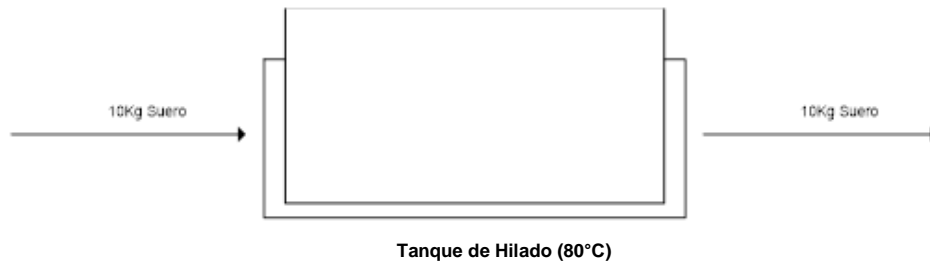
Figura No. 24: Balance de masa tanque de hilado
