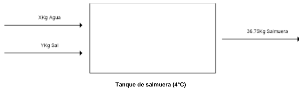
Figura No. 25: Balance de masa tanque de salmuera
