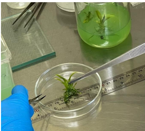
Figura 16. Método empleado para medición de raíces con regla y caja Petri de vidrio.
