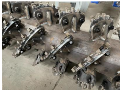
Figura 4: Rotor con cuchillas ensambladas por medio de pernos y tuercas
