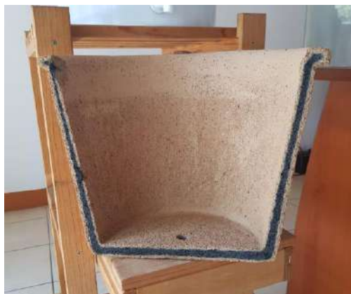
Figura No. 13 Estructura interna Ecofiltro
