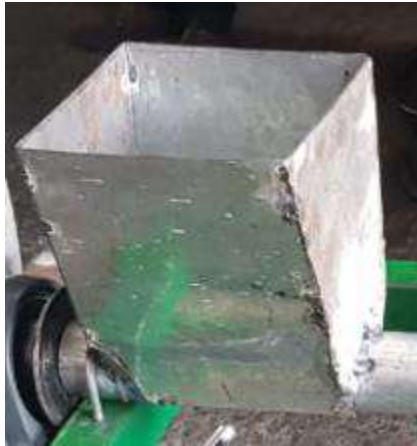
Figura No. 110 Vista superior de tolva de alimentación
