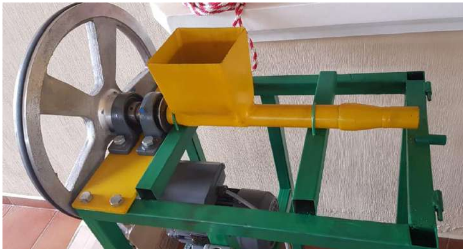
Figura No. 120 Briquetadora terminada con bandeja
