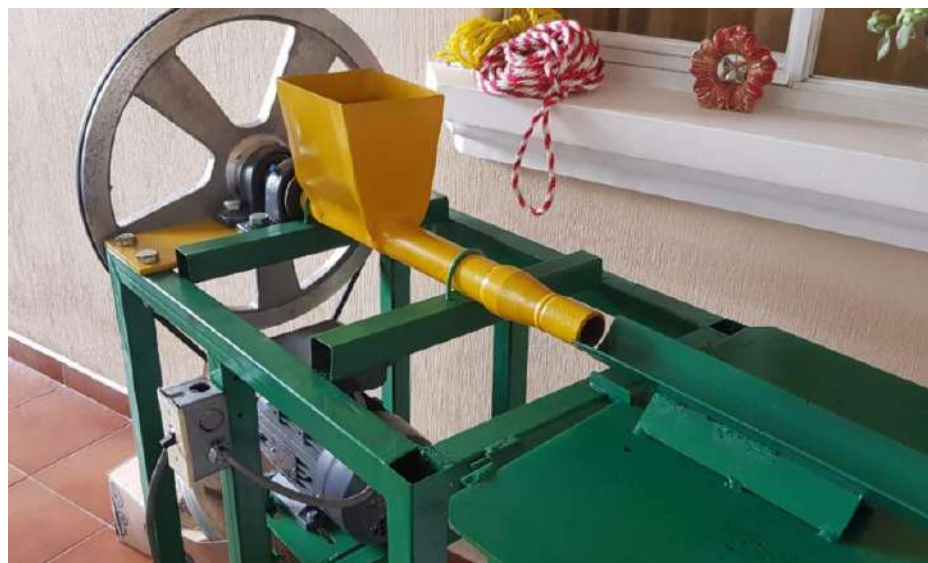
Figura No. 120 Briquetadora terminada con bandeja
