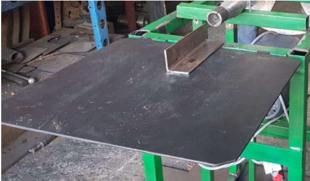
Figura No. 116 Instalación de bandeja con canal de salida
