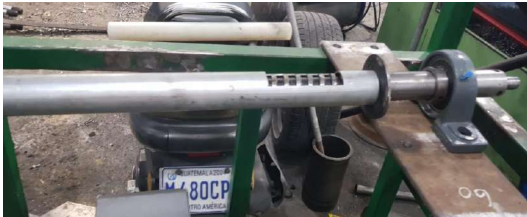
Figura No. 107 Prueba holgura camisa / tornillo sinfín
