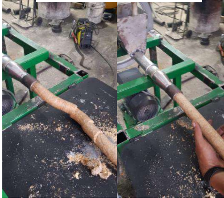
Figura No. 131 Briquetas con excelente adhesión
