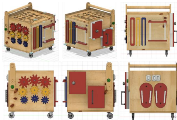
Figura 9. Representación del modelo 3D (propuesta 2) mostrando las vistas ortogonales (frontal, trasera y laterales) y vistas isométricas
