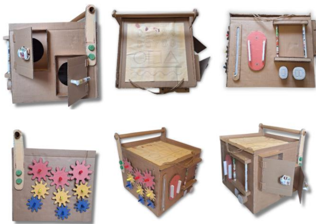
Figura 8. Prototipo físico de baja fidelidad (cartón) con modificaciones aplicadas tras la fase de prueba y evaluación
