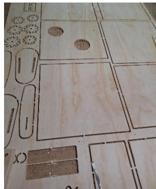
Figura 11. Registro del proceso de corte CNC para el prototipo de alta fidelidad
