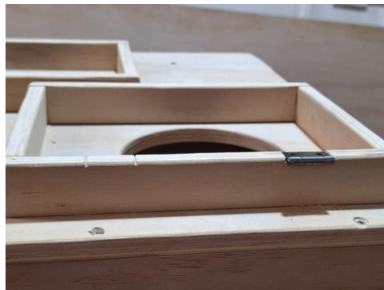
Figura 13. Montaje de la bisagra en el sistema de puertas
