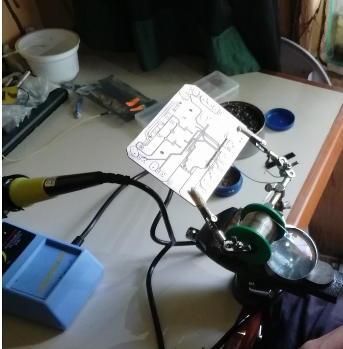
Figura 56: Inicio del proceso de soldadura de los componentes a la capa inferior de la placa.
