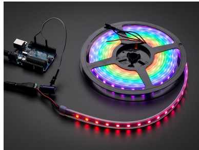
Figura 14: Tira de luces LED neopixel de Adafruit [34].
