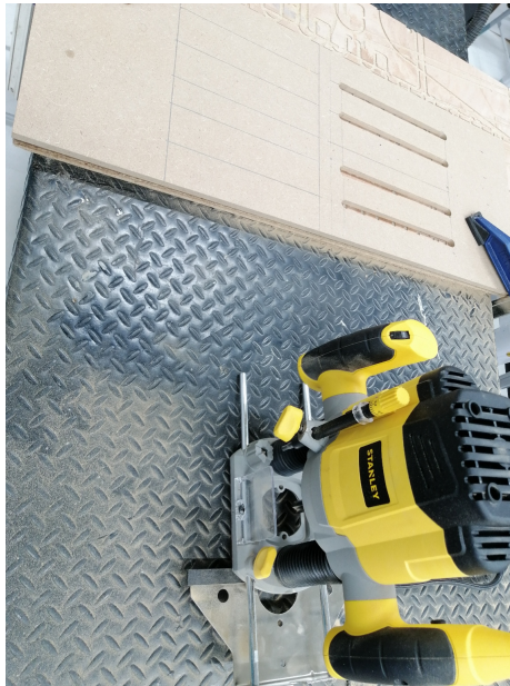
Figura 33: Corte de ranuras en repisa de MDF utilizando router manual.
