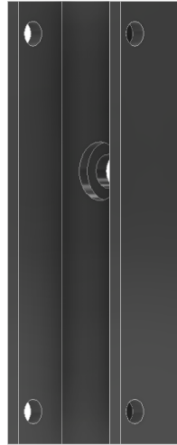
Figura 29: Soporte para ventiladores con tornillos de 0.25 pulg, vista frontal e isométrica.
