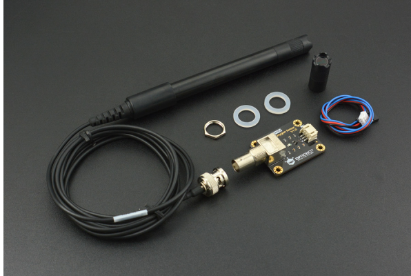
Figura 7: Sensor analógico de oxígeno disuelto [20].
