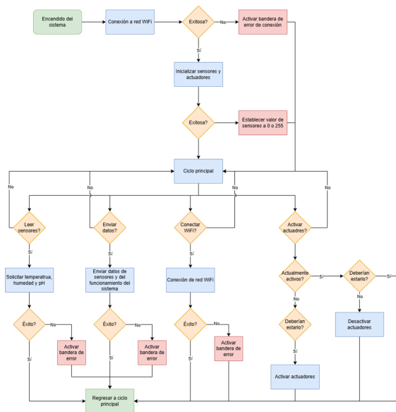
Figura 61: Diagrama de funcionamiento general del firmware desarrollado para controlar el sistema.
