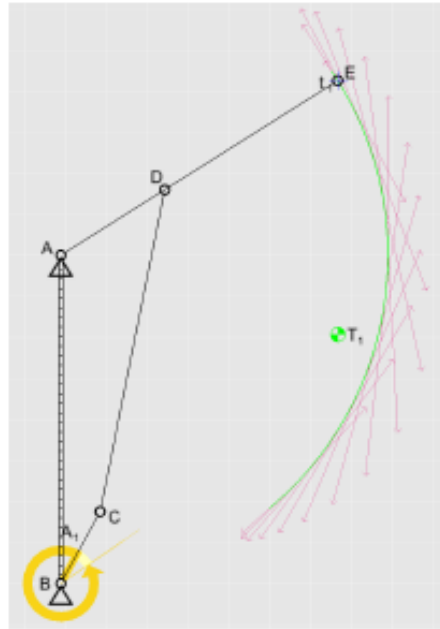
Figura 2: Simulación de mecanismo manivela-balancín.[1]
