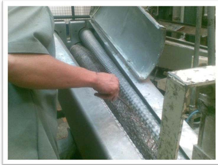
Figura 41. Cordón de caramelo a través de egalizador y troquel formador.
