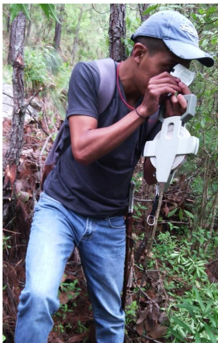
Medición de pendiente mediante el uso de clinómetro.
