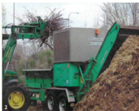
Gráfica 1. Maquinaria para transportar y cortar materia prima y formar la pila. Reproducida de la referencia (1) con atento permiso otorgado por JGPress.
