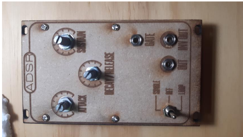
Figura A.8: Diseño del panel frontal con entradas, salidas y potenciómetros debidamente indicados.
