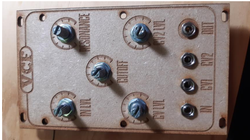
Figura A.3: Diseño del panel frontal con entradas, salidas y potenciómetros debidamente indicados.
