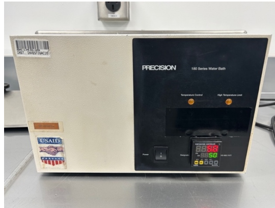
Figura 166. Baño térmico utilizado durante la experimentación
