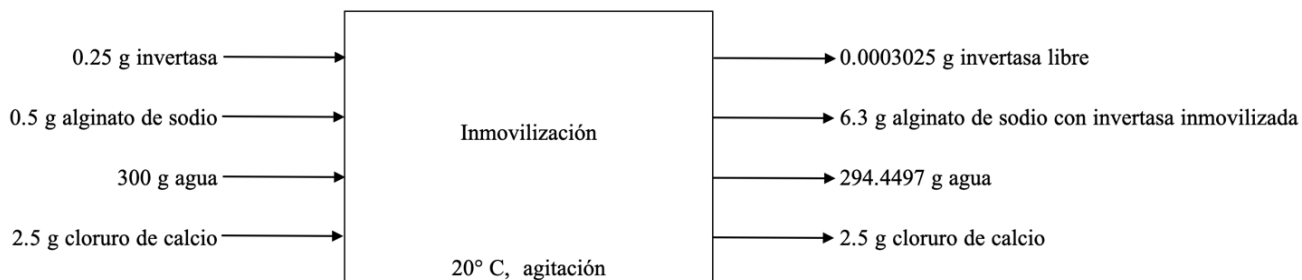
Figura 154. Balance de masa de la inmovilización de invertasa con alginato de sodio
