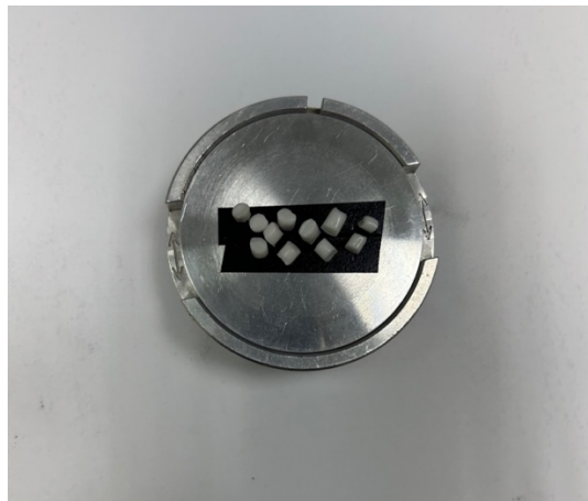
Figura 174. Muestra de la inmovilización con PHA funcionalizado al ser analizada con el microscopio electrónico de barrido
