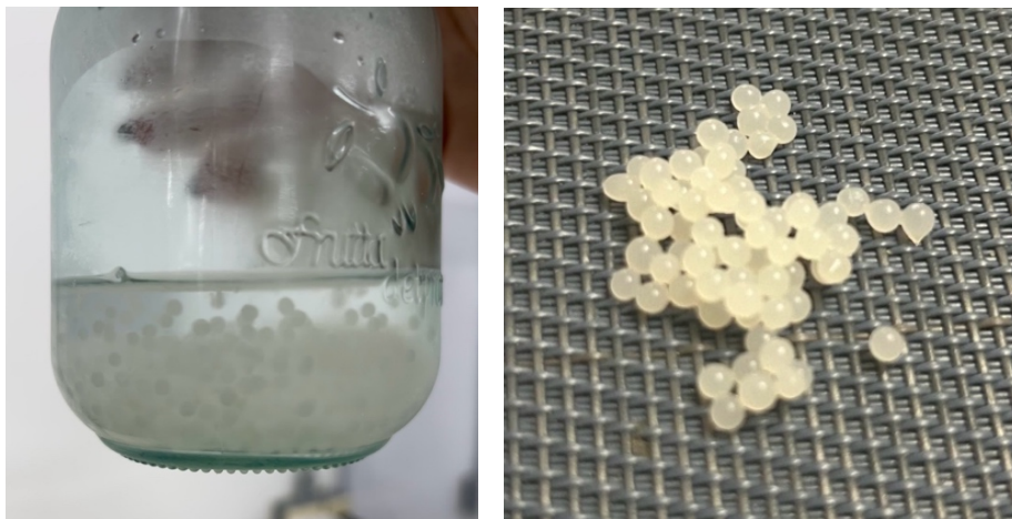
Figura 173. Inmovilización de invertasa con alginato de sodio
