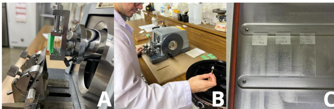
Figura 13: Cortes de las muestras y colocación en portaobjetos. A. Corte de la muestra en parafina. B. Colocación de la muestra cortada en baño de agua. C. Portaobjetos en plancha a  $60^\circ\text{C}$ .
