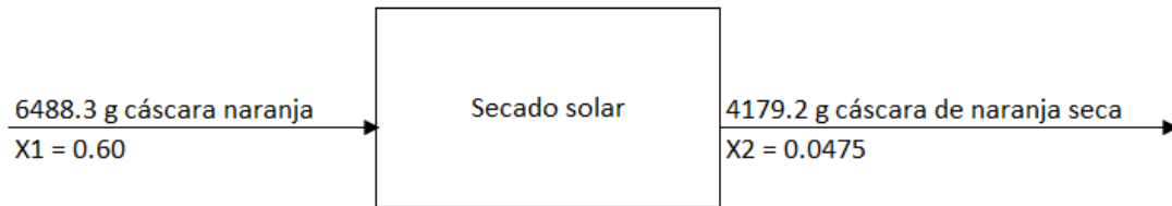
Figura 14: Balance de masa del secado solar
