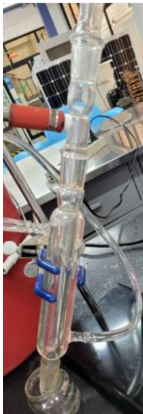
Imagen 7. Condensador de vidrio utilizado para la pirólisis.
