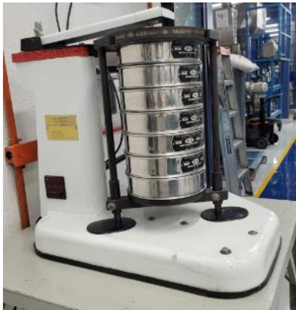
Imagen 4. Tamizadora vibratoria vertical.
