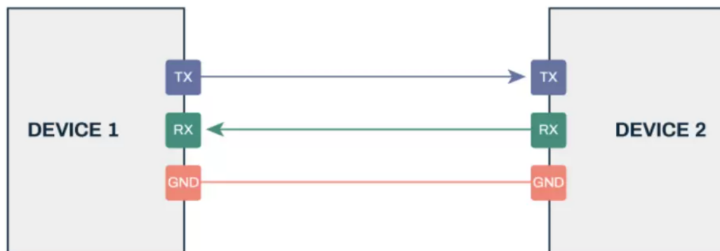
Figura 12: Diagrama de conexión del protocolo UART [12].
