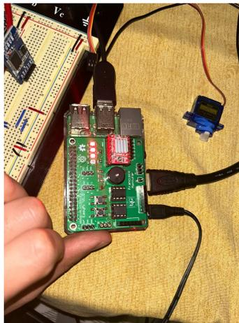
Figura 61: Contador de 4 bits utilizando LEDs y pulsadores
