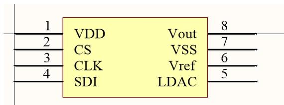
Figura 120: Símbolo de esquemático de MCP 4921
