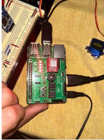
Figura 60: Contador de 4 bits utilizando LEDs y pulsadores
