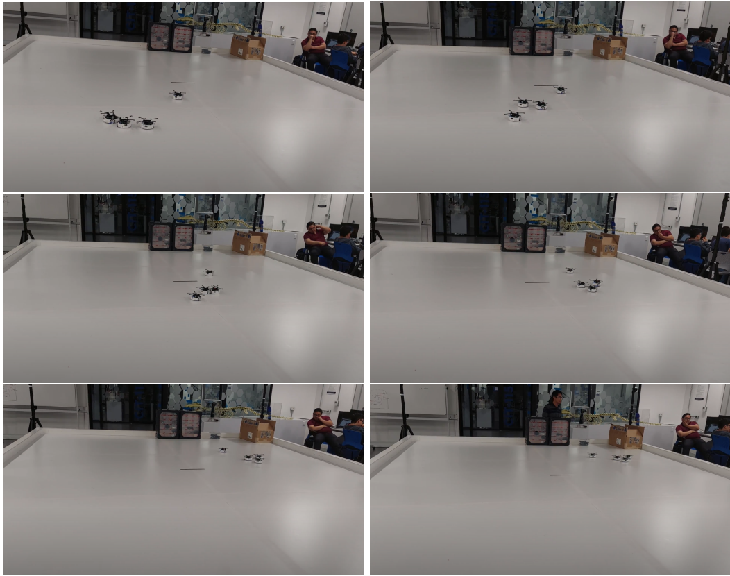
Figura 70: Secuencia Experimento 1: tercera fase del algoritmo, movimiento de líder hacia objetivo manteniendo formación.
