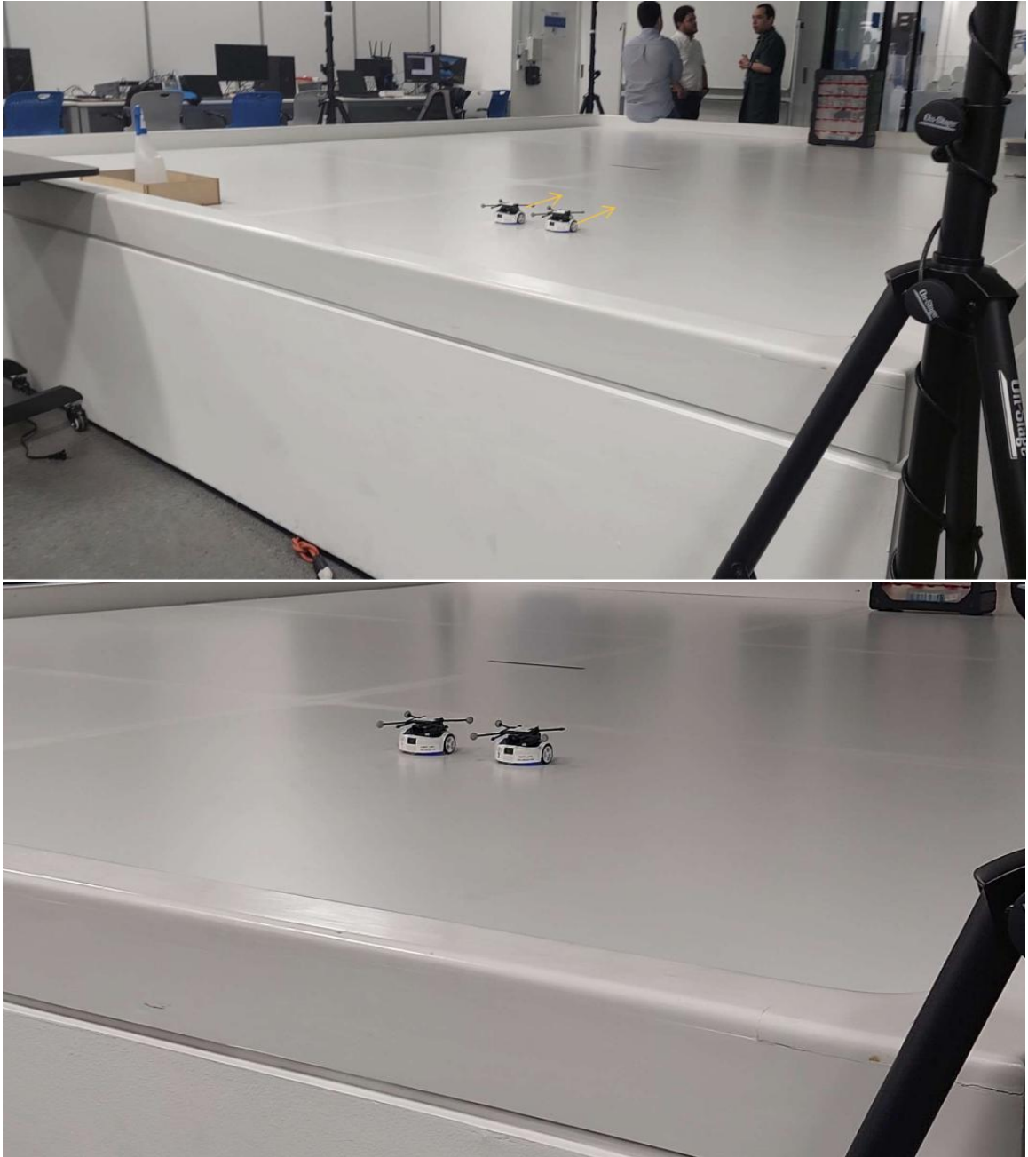
Figura 38: Envío de instrucciones para mover en línea recta a agentes Pololu, usando las funciones migradas a Python.
