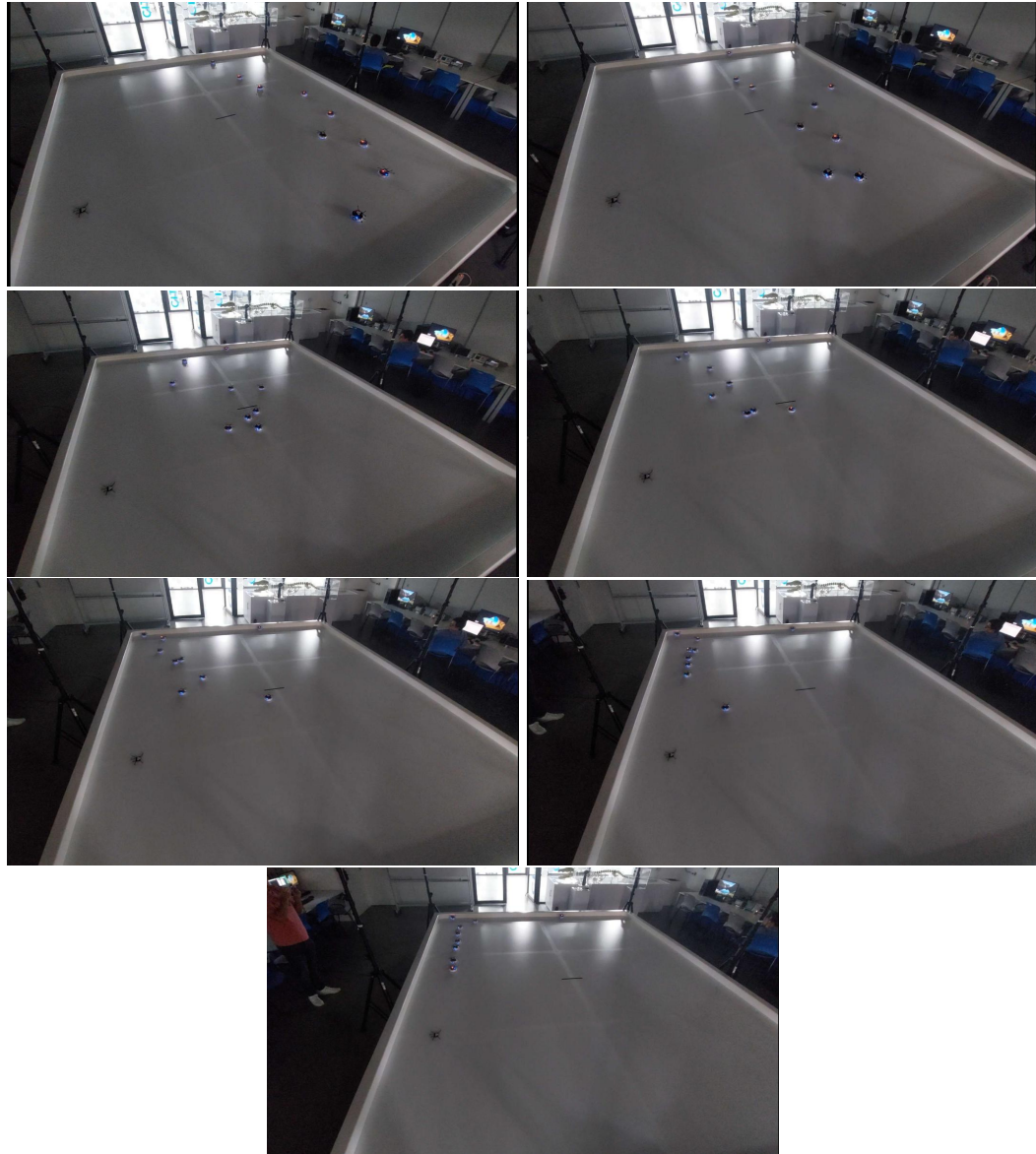
Figura 60: Secuencia (izquierda a derecha) de movimiento de 9 agentes físicos y 1 agente inmóvil (marcador) hacia objetivos virtuales en forma de L invertida, prueba 2.
