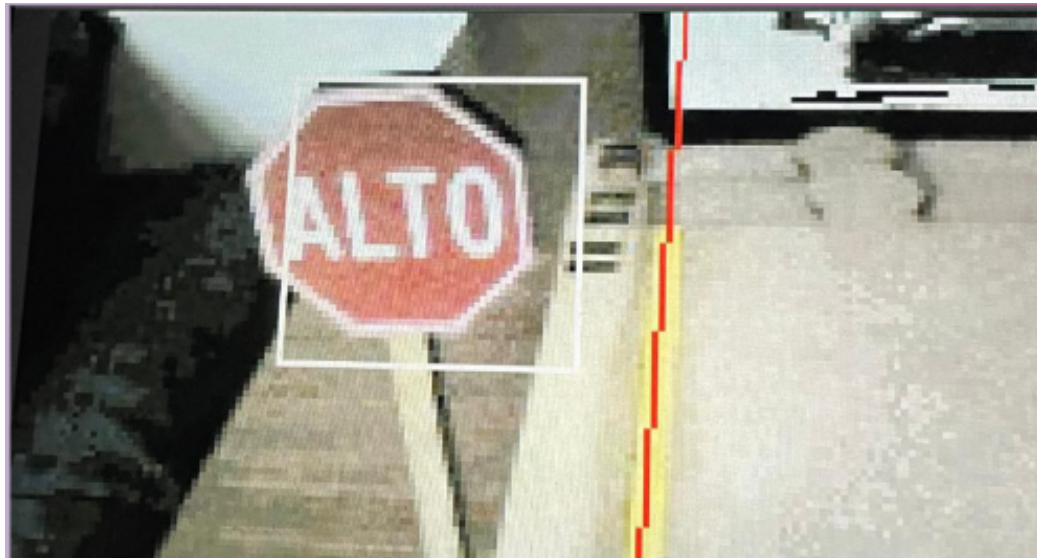
Figura 34: Resultado de aplicación de algoritmo de detección de señal de alto con Haar cascade .
