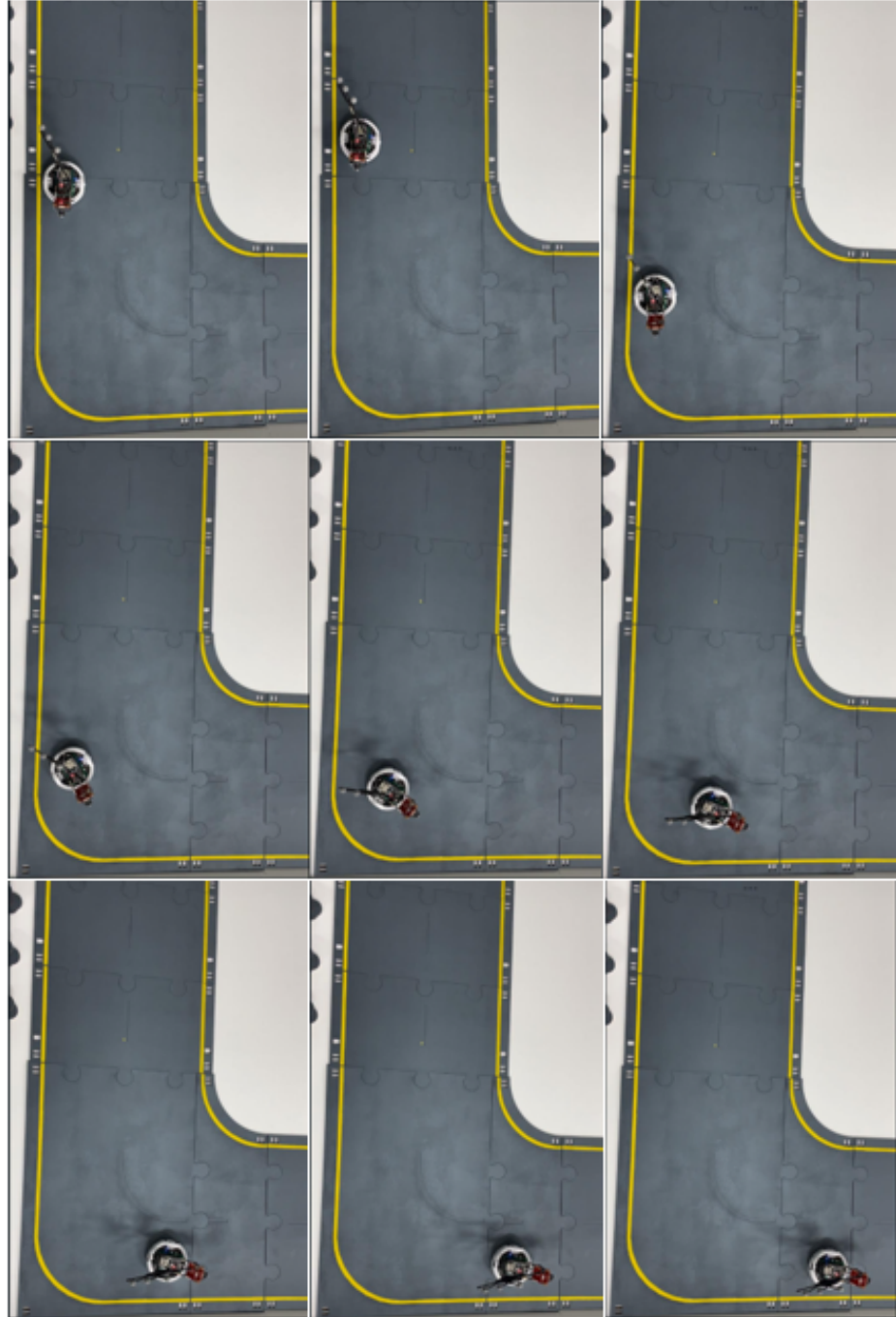
Figura 59: Fotogramas del algoritmo detección de carril amarillo implementado.
