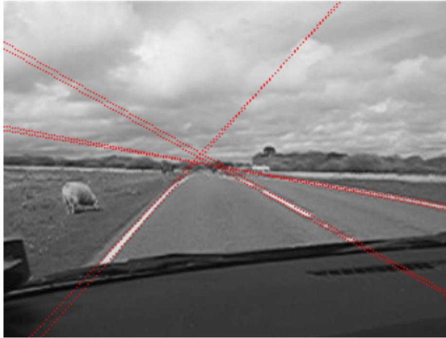
Figura 7: Ejemplo de detección de líneas de carriles utilizando el algoritmo de RANSAC [7].
