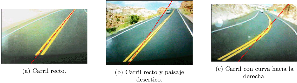
Figura 57: Detección de carriles en carretera hacia la ruta estatal 123 en el parque nacional Pinchot.
