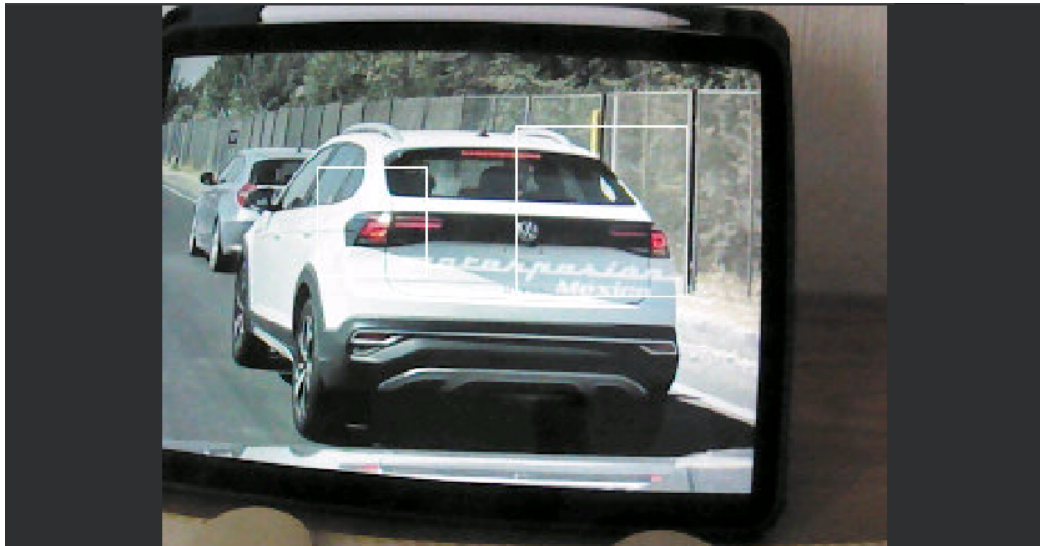
Figura 35: Resultado de aplicación de algoritmo de detección vehículo con Haar cascade .
