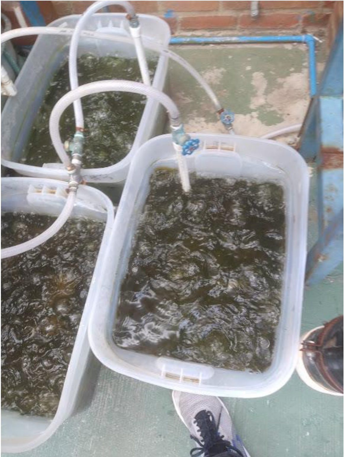
Figura 75. Corrida 3 variación de agua suavizada a agua residual gris en los 3 reactores abiertos sin agitación de 25 litros [23 de junio de 2023].
