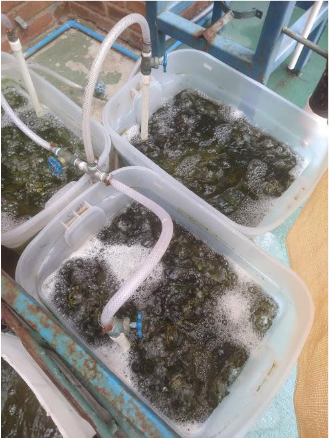
Figura 74. Corrida 3 variación de agua suavizada a agua residual gris en los 3 reactores abiertos sin agitación de 25 litros [19 de junio de 2023].
