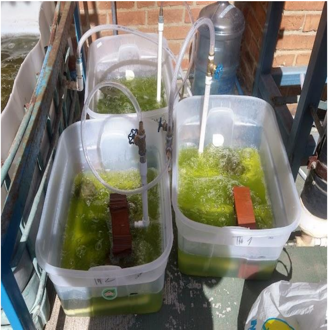
Figura 56. Corrida 1 variación de salinidad fluctuante en los 3 reactores abiertos sin agitación de 25 litros [2 febrero de 2023].
