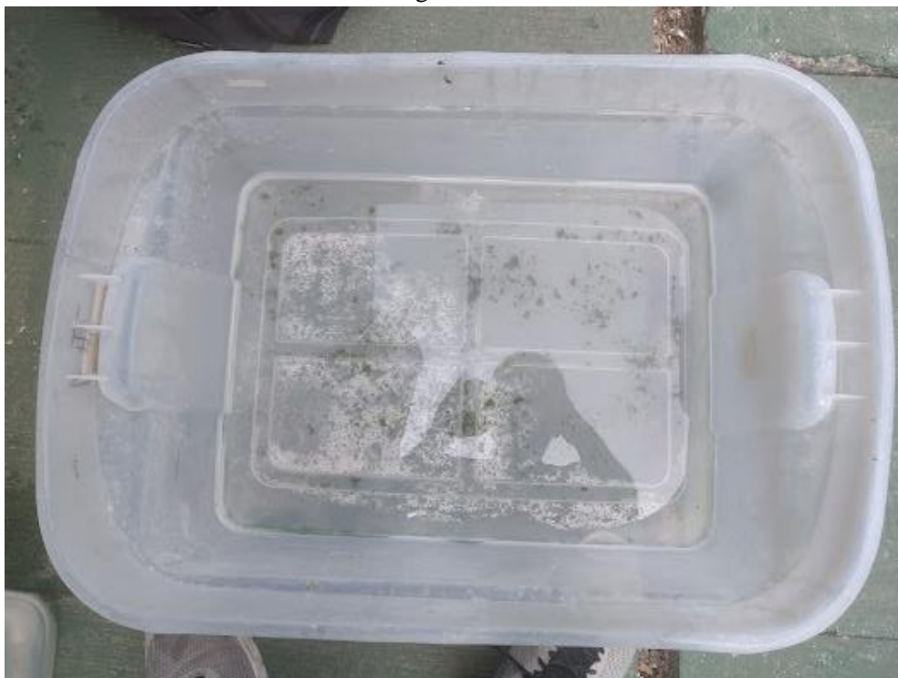
Figura 20. Caja de plástico “56 Lt” Guateplast utilizada como el tanque del reactor abierto sin agitación.
