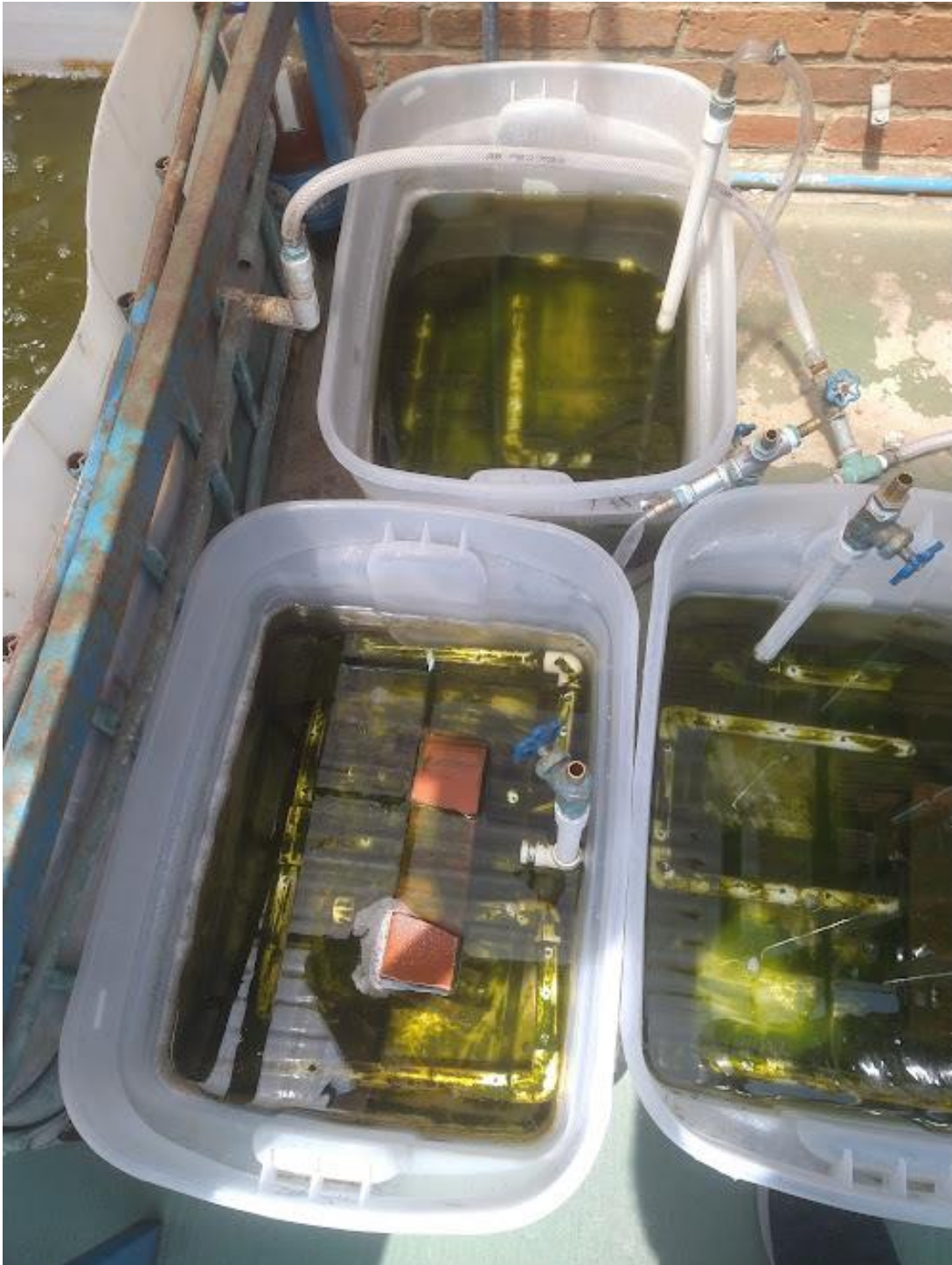
Figura 61. Corrida 1 variación de salinidad fluctuante en los 3 reactores abiertos sin agitación de 25 litros [10 de marzo de 2023].
