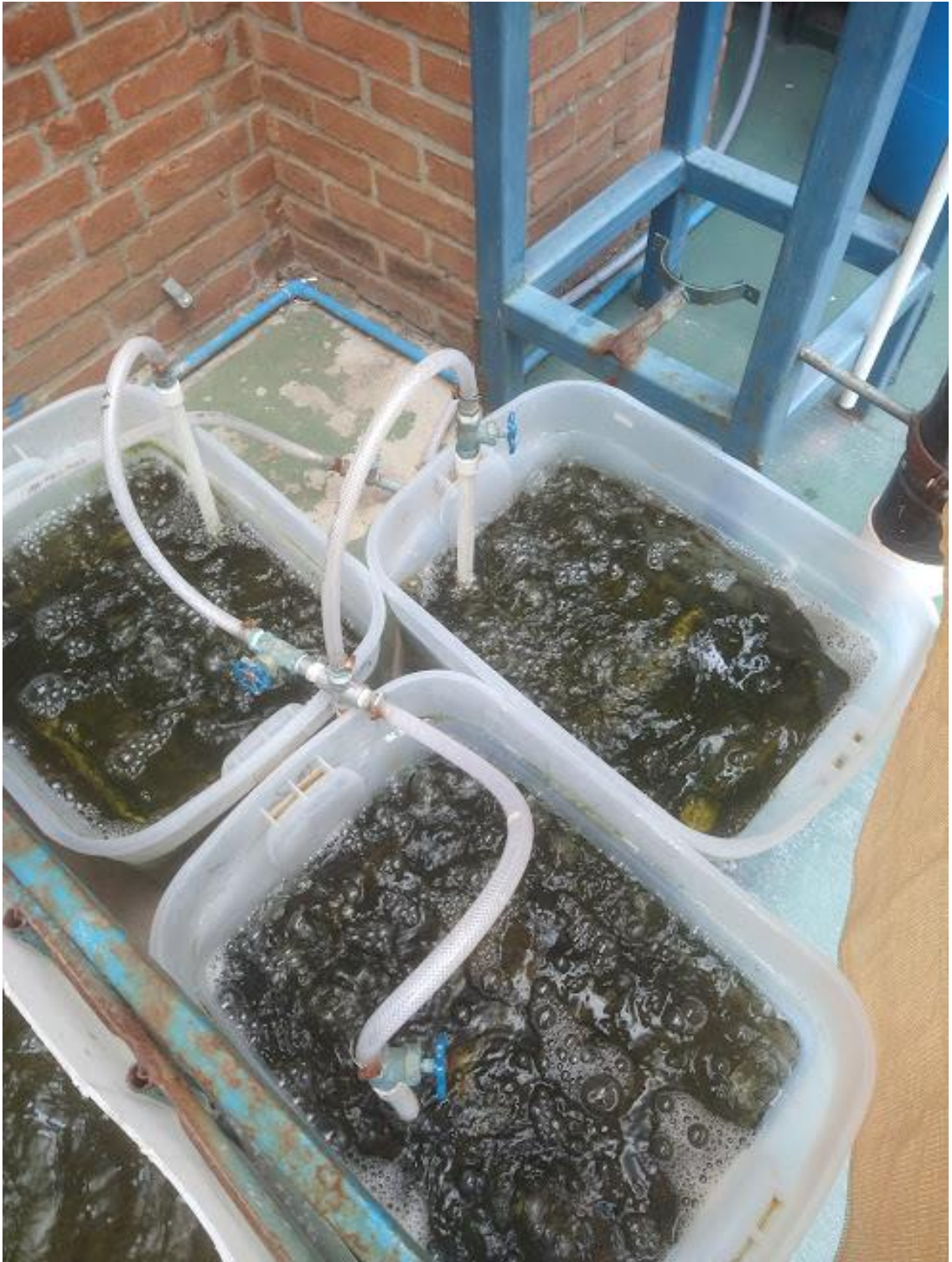
Figura 76. Corrida 3 variación de agua suavizada a agua residual gris en los 3 reactores abiertos sin agitación de 25 litros [30 de junio de 2023].
