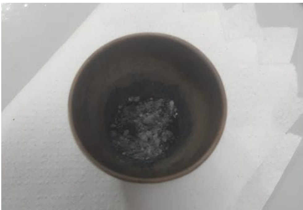
Figura 51. Muestra de biomasa luego de la prueba de ceniza dentro de una mufla0.
