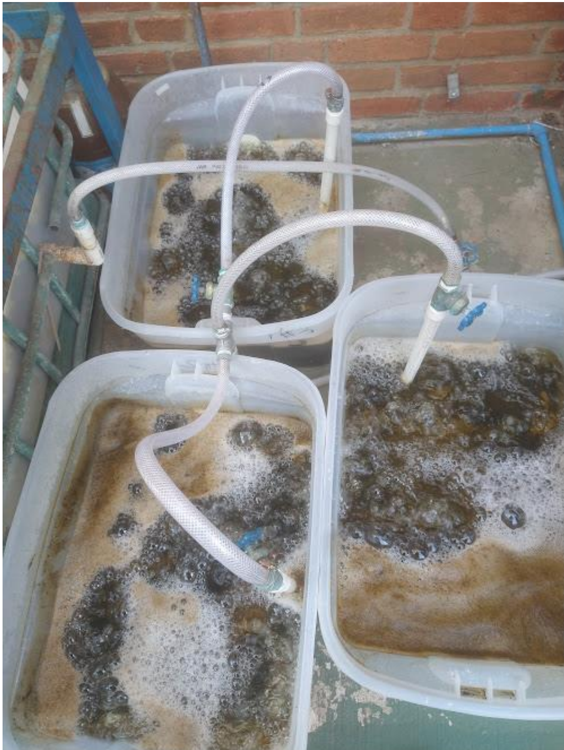
Figura 69. Corrida 2 variación de nutrientes y minerales (medio f/2) periódico en los 3 reactores abiertos sin agitación de 25 litros [4 de mayo de 2023].
