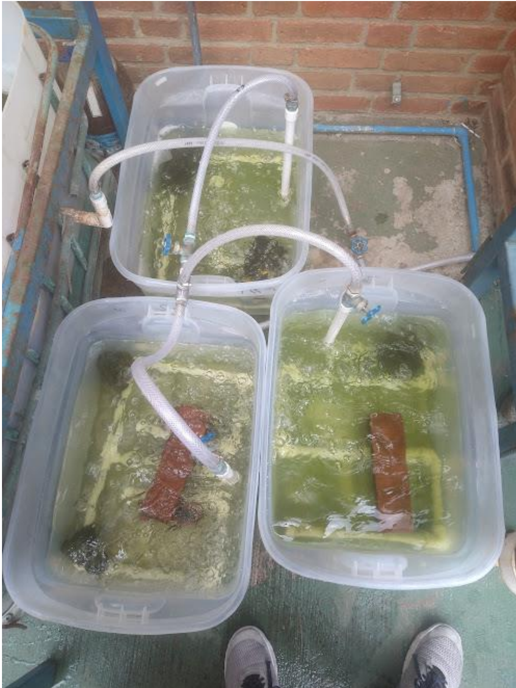
Figura 62. Corrida 2 variación de nutrientes y minerales (medio f/2) periódico en los 3 reactores abiertos sin agitación de 25 litros [18 de marzo de 2023].
