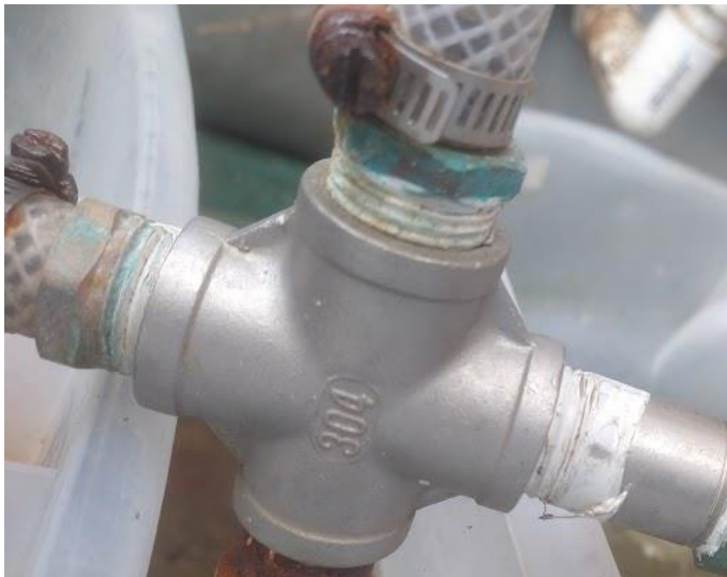
Figura 29. Sección cruz de redirección de los gases en el sistema de aireación externo
