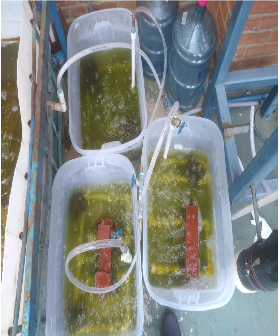
Figura 57. Corrida 1 variación de salinidad fluctuante en los 3 reactores abiertos sin agitación de 25 litros [15 de febrero de 2023].
