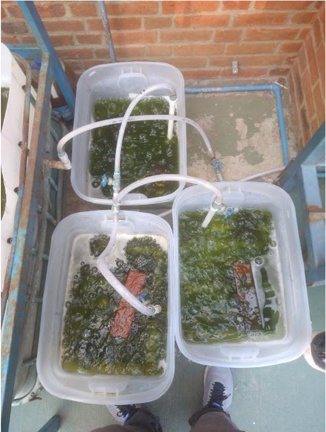
Figura 65. Corrida 2 variación de nutrientes y minerales (medio f/2) periódico en los 3 reactores abiertos sin agitación de 25 litros [29 de marzo de 2023].
