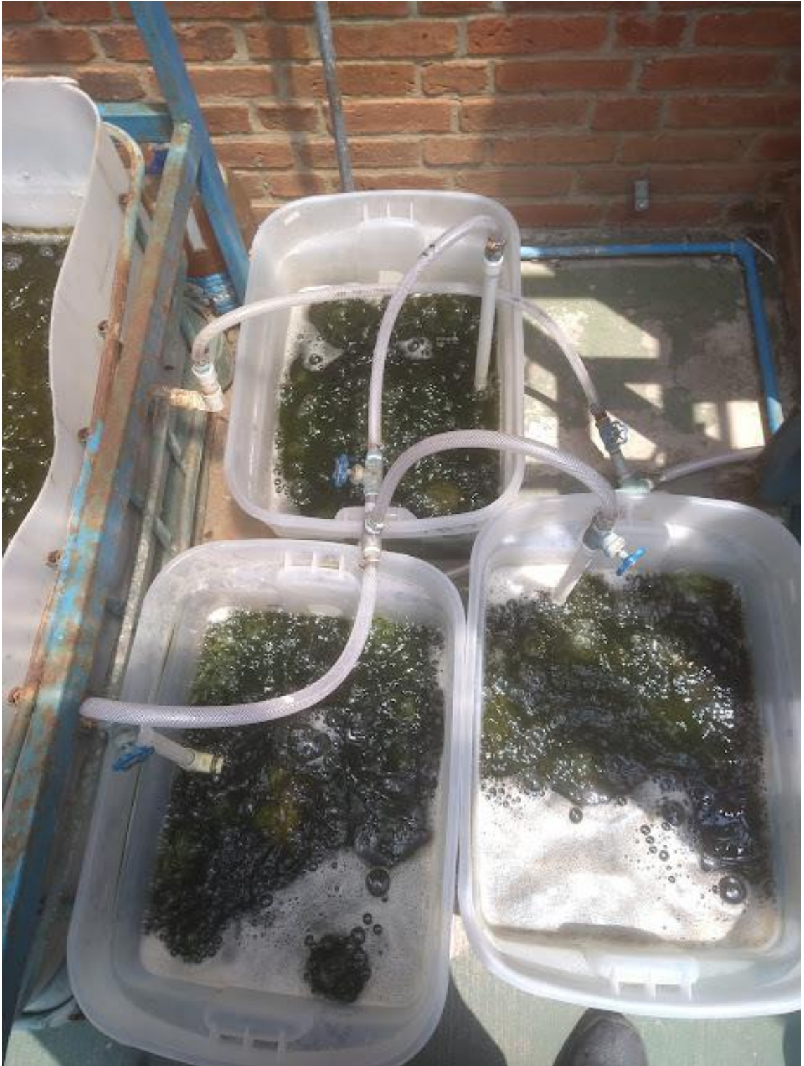
Figura 66. Corrida 2 variación de nutrientes y minerales (medio f/2) periódico en los 3 reactores abiertos sin agitación de 25 litros [12 de abril de 2023].
