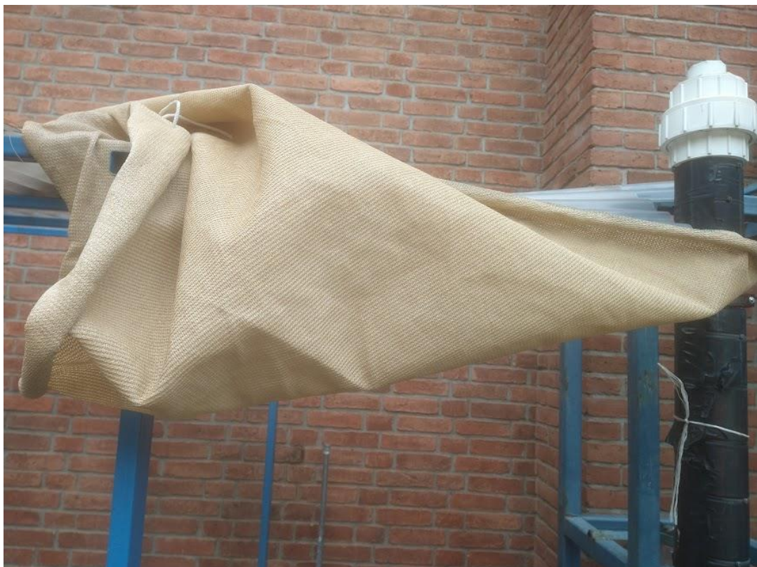
Figura 23. Cortina de paja utilizada para mitigar el efecto de la intensidad lumínica en los cultivos de microalgas.
