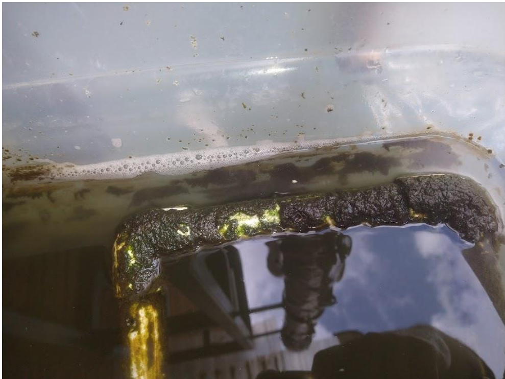
Figura 53. Acercamiento al tanque 3 con el sistema de aireación 3 y la biomasa de microalga pegada en ambas durante la recolección de la corrida 3 el 4/7/2023.
