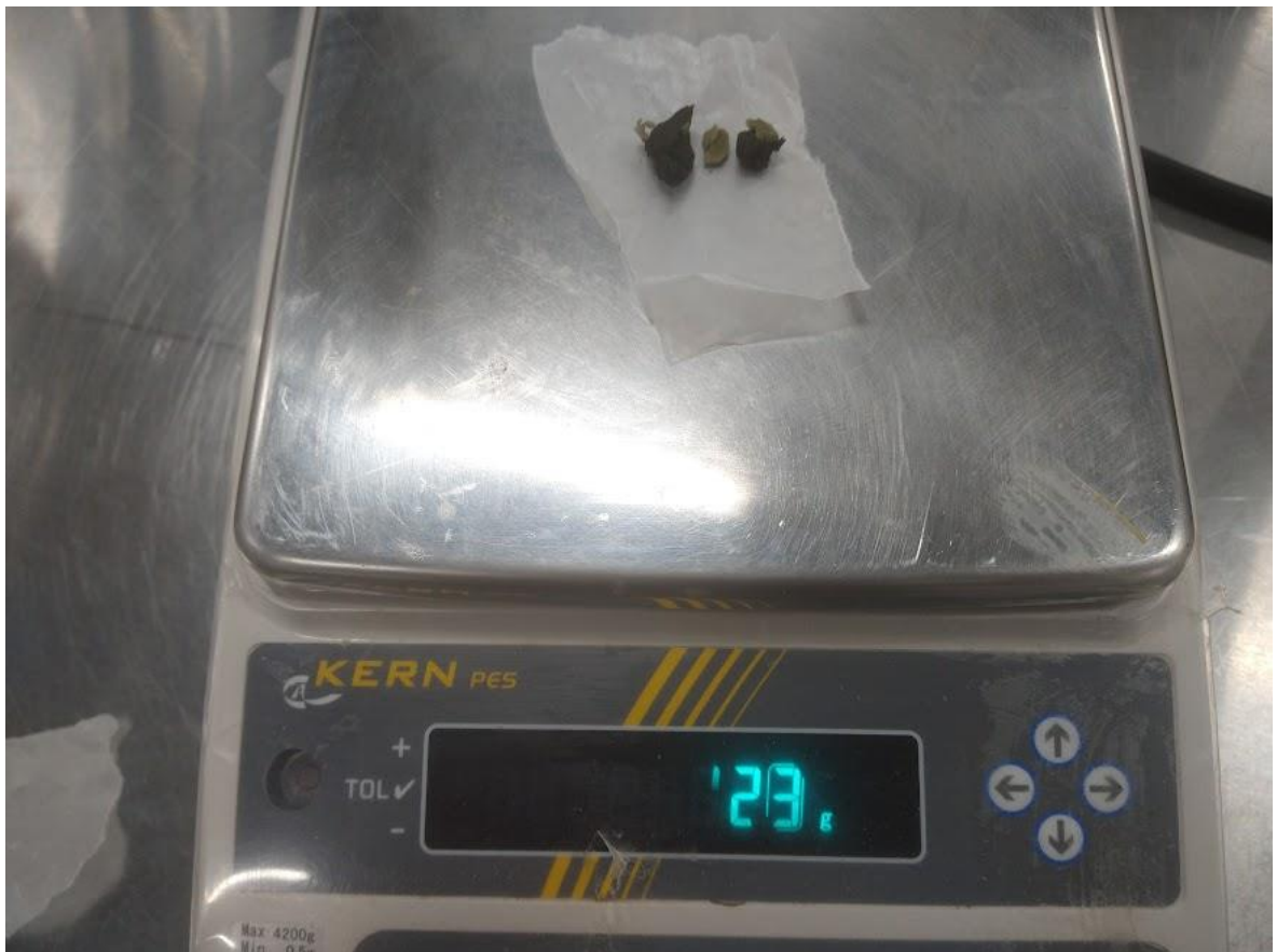
Figura 39. Balanza analítica Kern con muestra de secado corrida 1 hora 1.
