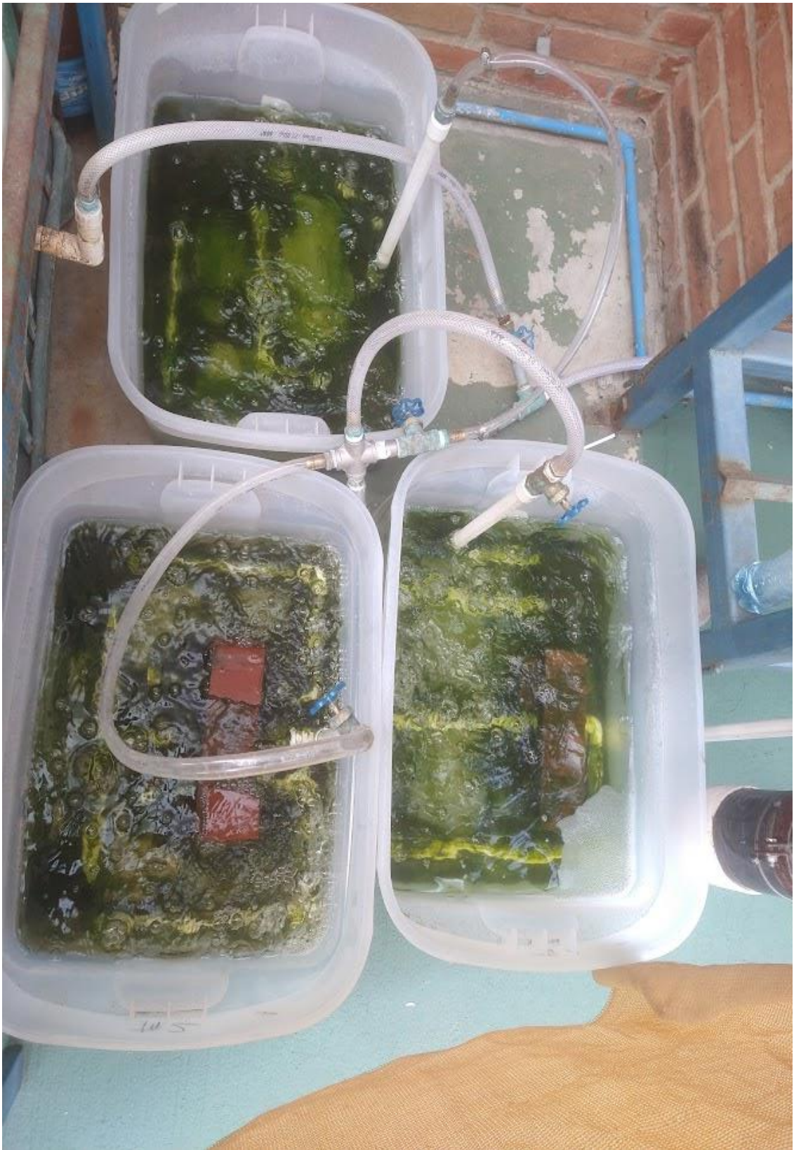
Figura 59. Corrida 1 variación de salinidad fluctuante en los 3 reactores abiertos sin agitación de 25 litros [1 de marzo de 2023].
