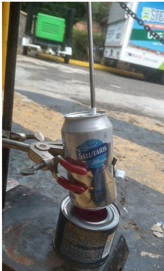
Figura 45. Sistema casero de imitación a una chimenea a nivel pequeña para la medición de gases de combustión a.
