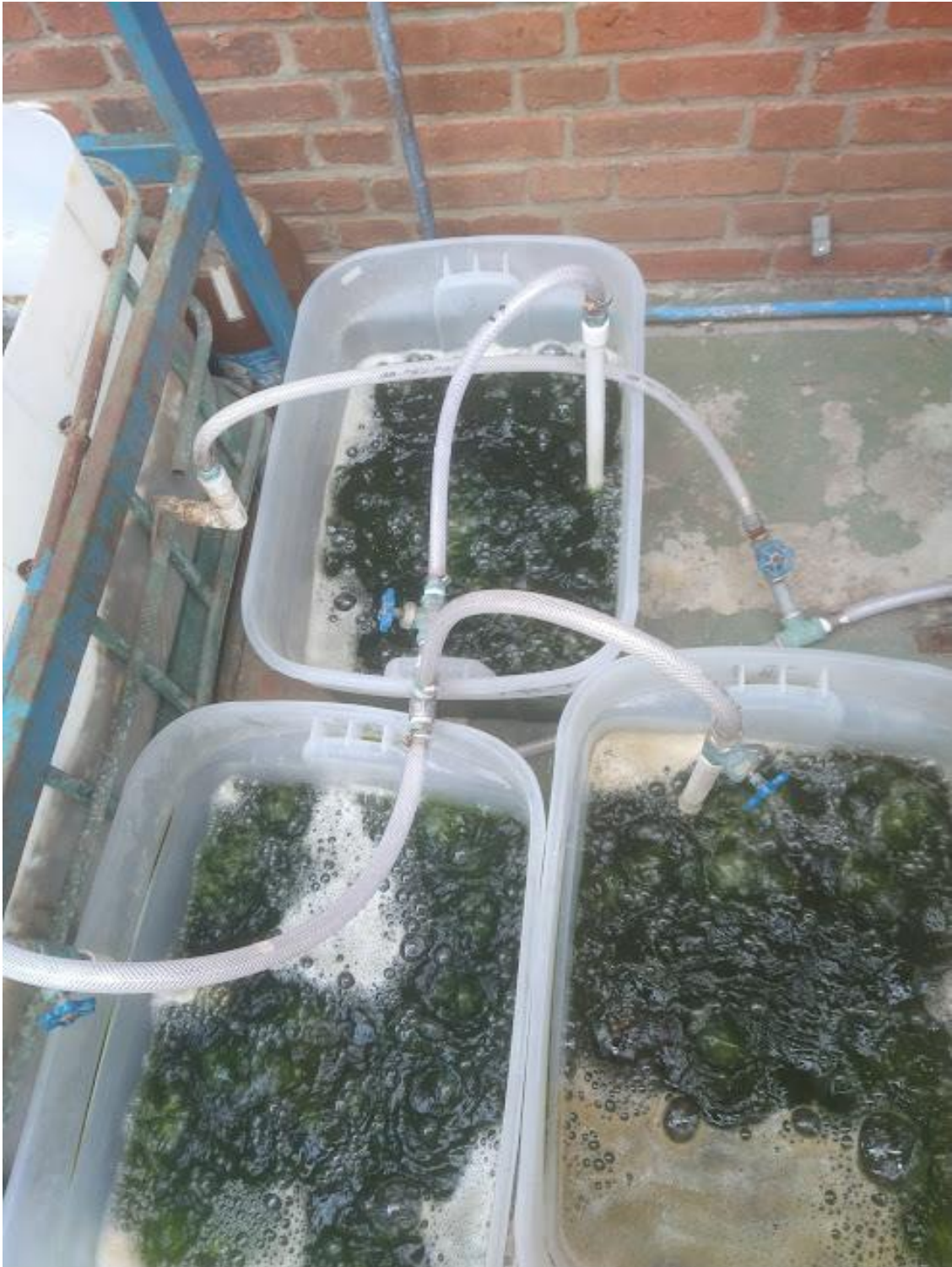
Figura 67. Corrida 2 variación de nutrientes y minerales (medio f/2) periódico en los 3 reactores abiertos sin agitación de 25 litros [17 de abril de 2023].
