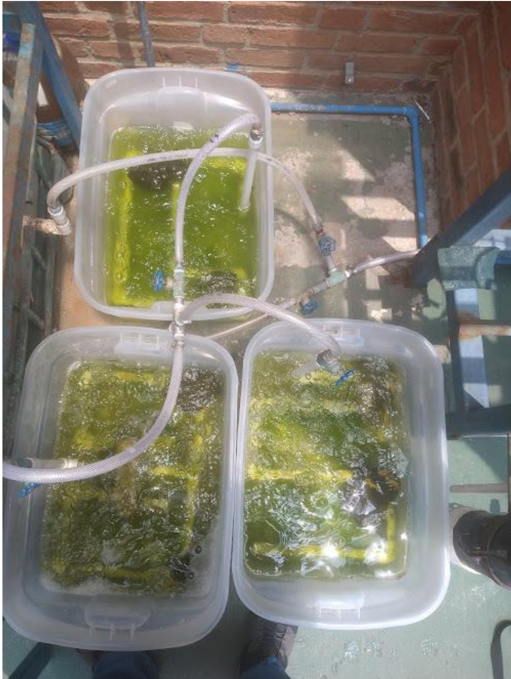
Figura 70. Corrida 3 variación de agua suavizada a agua residual gris en los 3 reactores abiertos sin agitación de 25 litros [19 de mayo de 2023].
