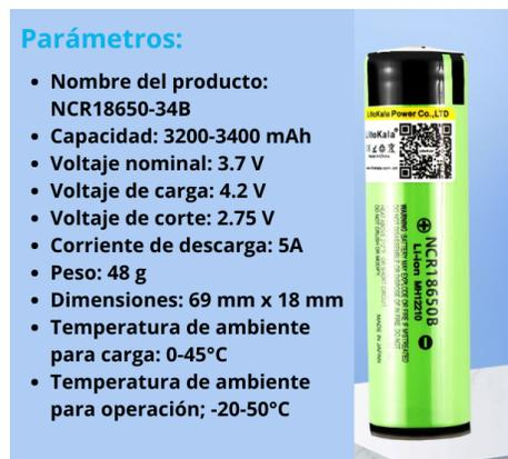
*Nota:* información sobre las características de una celda Li-Ion LiitoKala NCR18650B. Adaptado y traducido de (LiitoKala, 2023).
