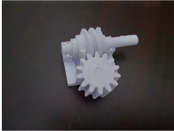
Figura 28: Engrane y tornillo sin fin impresos en PLA.
