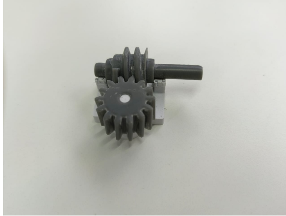
Figura 30: Engrane y tornillo sin fin impresos en Resina.
