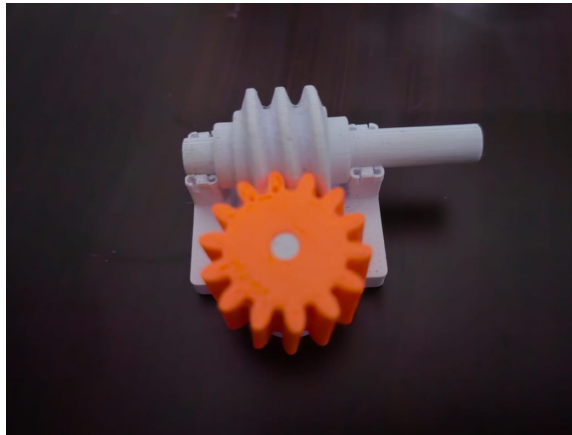
Figura 31: Engrane y tornillo sin fin impresos en PETG.
