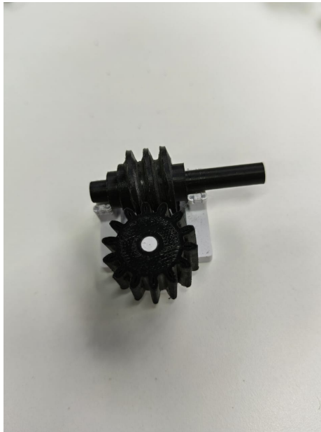
Figura 29: Engrane y tornillo sin fin impresos en ASA.
