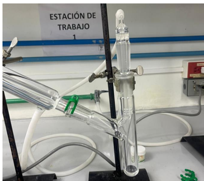
Figura #42. Evidencia fotográfica de la destilación de cloroformo para la extracción de aceite esencial de toronja 2.
