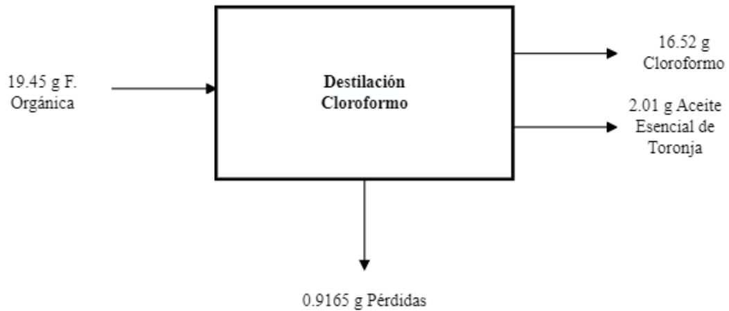
Figura #31. Balance de masa del sistema de destilación de cloroformo para la extracción de aceite esencial de toronja con pretratamiento ultrasónico de 40 minutos.
