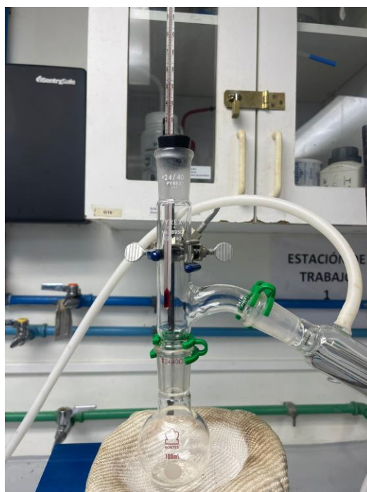
Figura #41. Evidencia fotográfica de la destilación de cloroformo para la extracción de aceite esencial de toronja 1.
