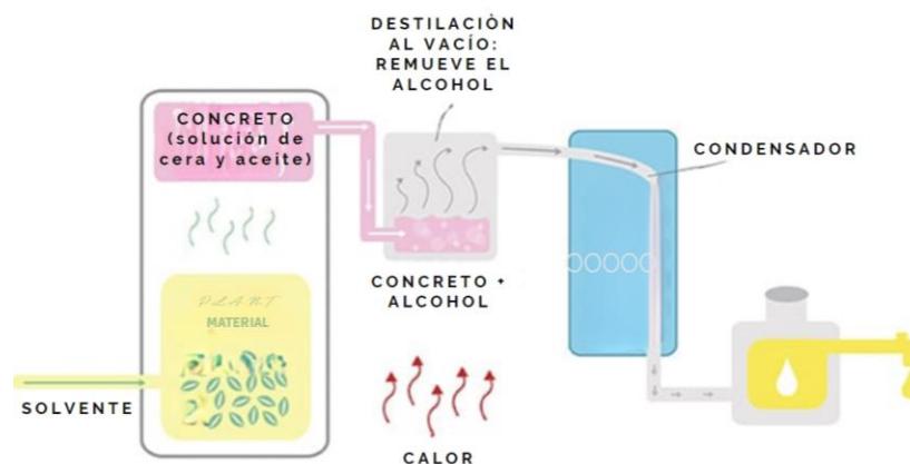
Figura #12. Proceso de extracción de aceites esenciales por solventes
