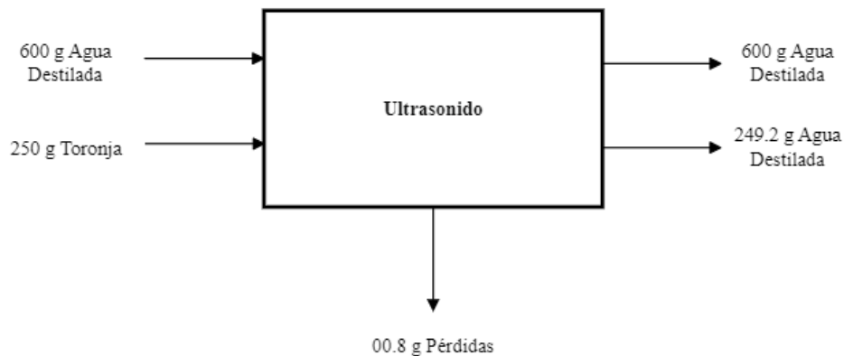
Figura #27. Balance de masa del sistema de baño ultrasónico para la extracción de aceite esencial de toronja de 40 minutos.
