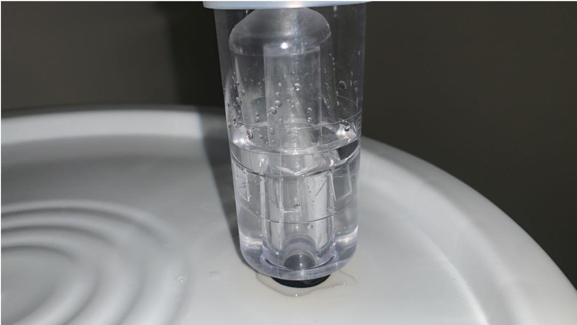
Figura No. 35: Adaptación de trampa de gases.
