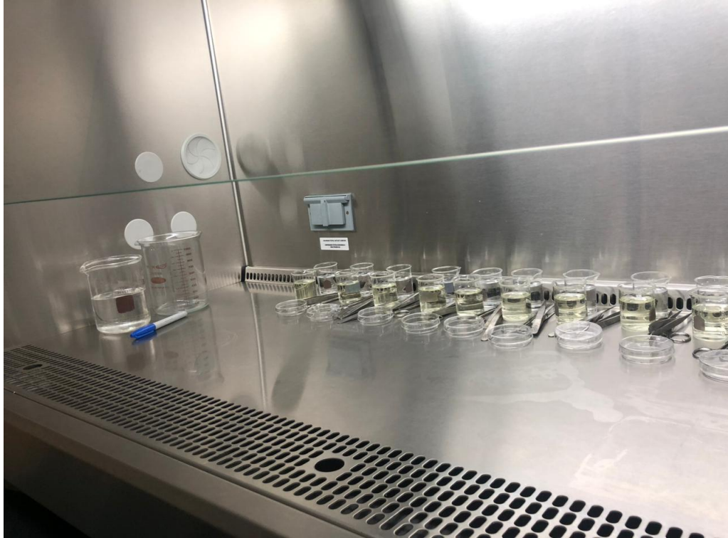
Figura 12.3: Preparación de materiales para la disección en campana de bioseguridad B2.
