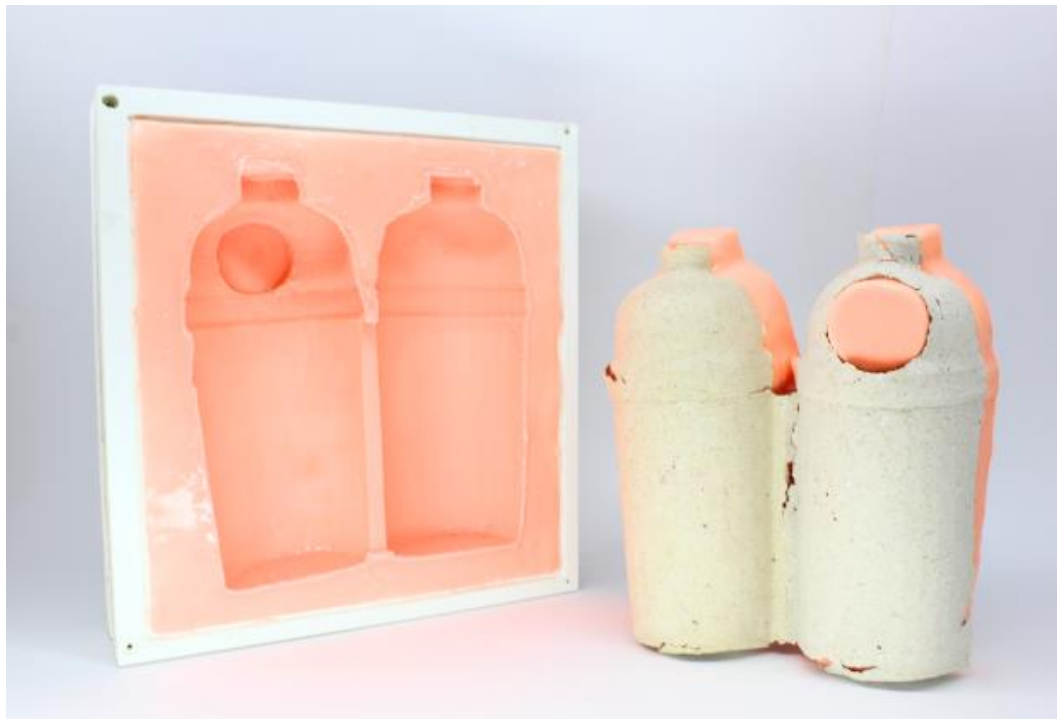
Figura 33. Molde de silicón y prototipo de bagazo empaque Tanqueray Gin Fuente: Elaboración propia
