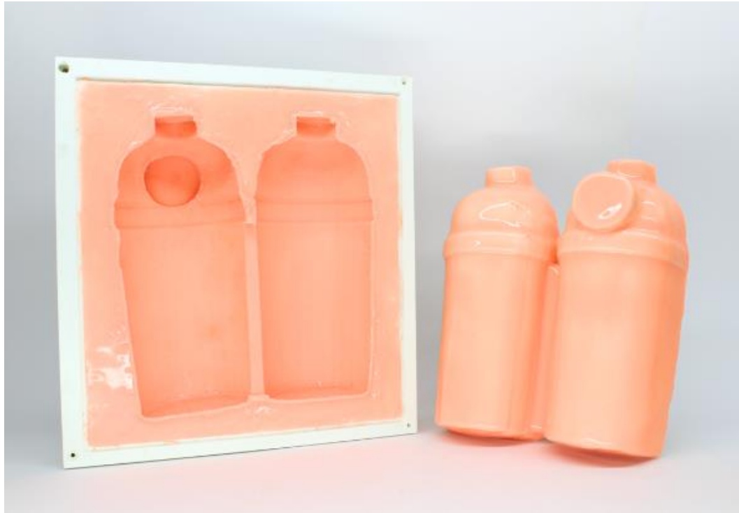
Figura 32. Piezas molde final empaque Tanqueray Gin Fuente: Elaboración propia
