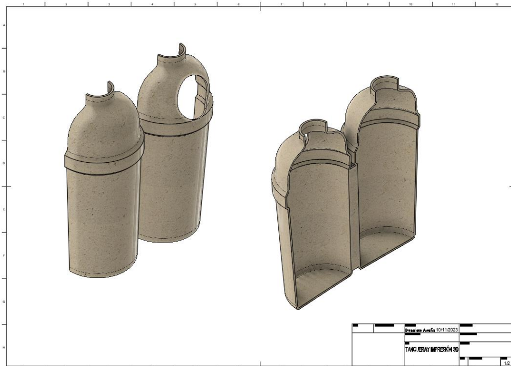
Figura 13. Vistas isométricas modelo 3D empaque Tanqueray Gin Fuente: Elaboración propia
