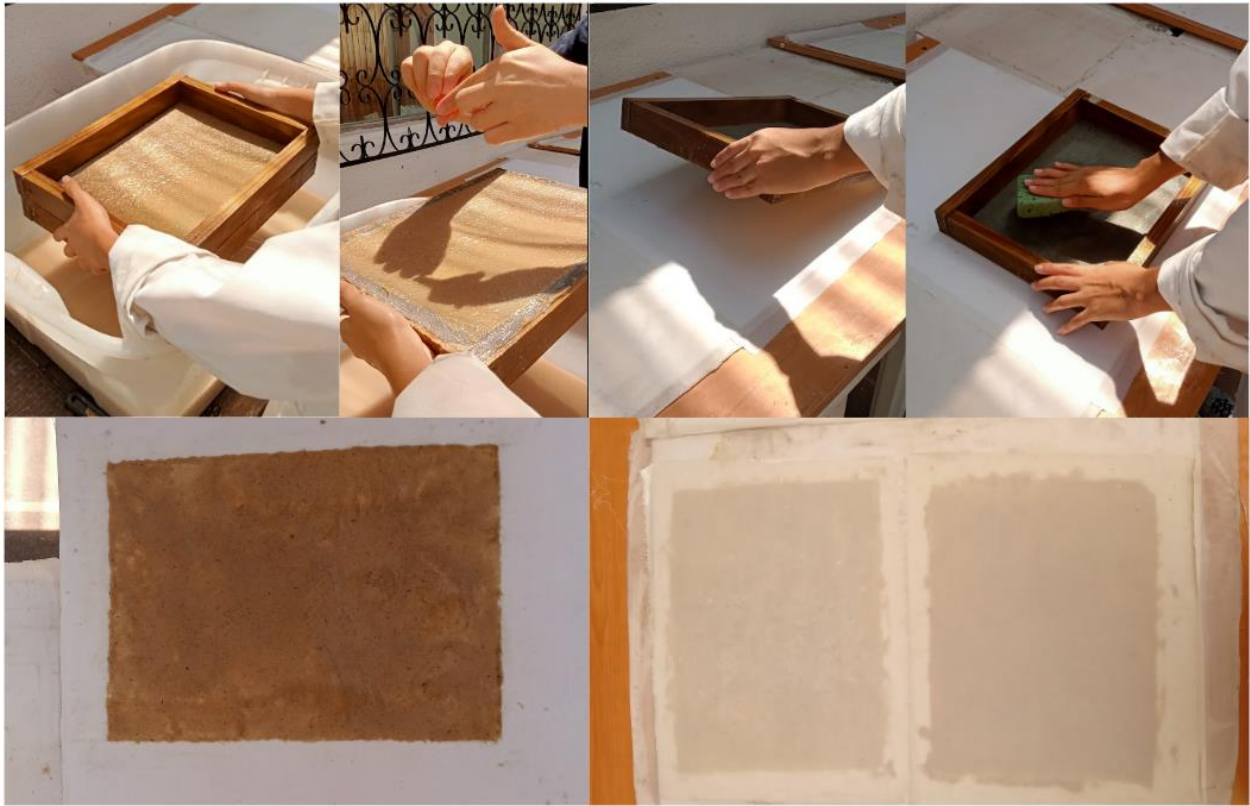
Figura 58. Proceso de fabricación de papel de bagazo con semillas Fuente: Elaboración propia
