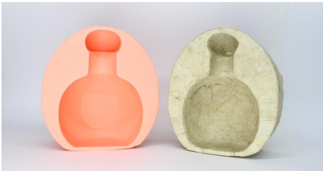
Figura 27. Molde de silicón y pieza interna de bagazo empaque Don Julio Tequila Fuente: Elaboración propia
