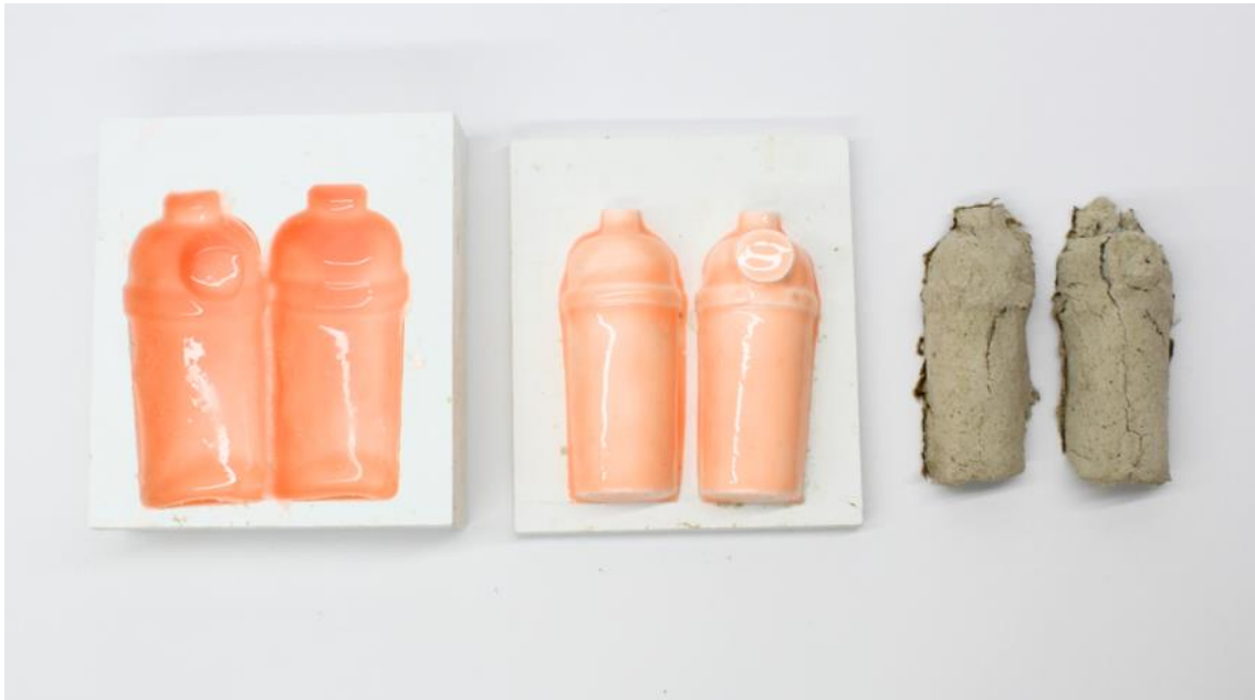
Figura 19. Maqueta a escala moldes empaque Tanqueray Gin Fuente: Elaboración propia
