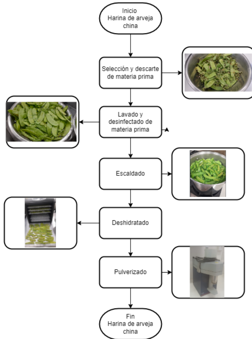
Ilustración 3 Diagrama de flujo para el desarrollo de harina de arveja china de descarte
