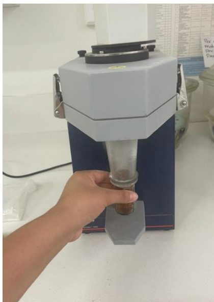
Figura 10 Proceso de triturado de cascara de camarón
